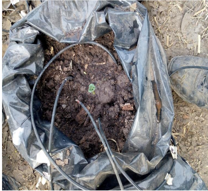
Figura 3: Termistores a 0 cm, 2 cm, 12 cm y 25 cm de profundidad
