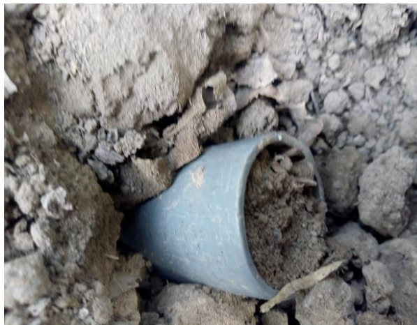
Figura 4: Extracción de suelo para la evaluación humedad gravimétrica
