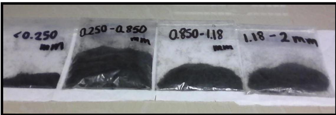
Muestras lavadas, secadas, cortadas, tamizadas y separadas por tamaño (en mm)
