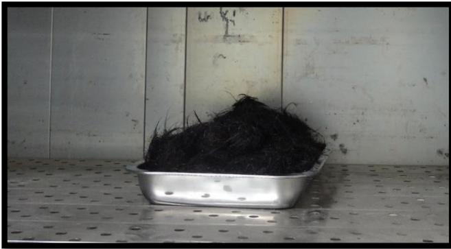
Secado de la muestra en la estufa a 40°C
