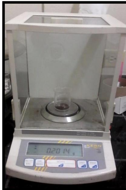
Pesada de la muestra de bioadsorbente para el proceso de bioadsorción
