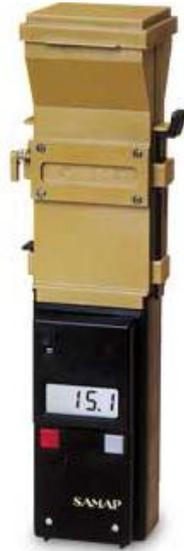
Figura 16. Medidor de Humedad utilizado para Granos SAMAP H40.
