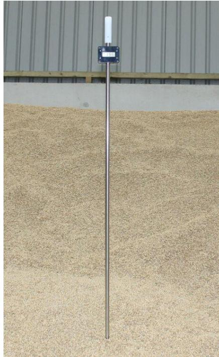
Figura 15: Termómetro tipo lanza.
