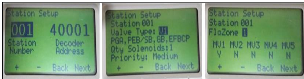
Figura 62: Configuración de estaciones (válvulas)
