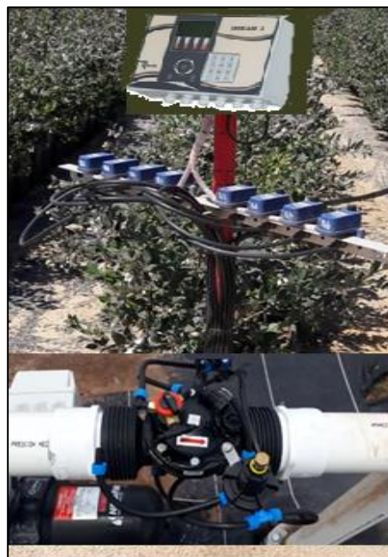
Figura 5: Accionamiento mediante mando de operación hidráulico
