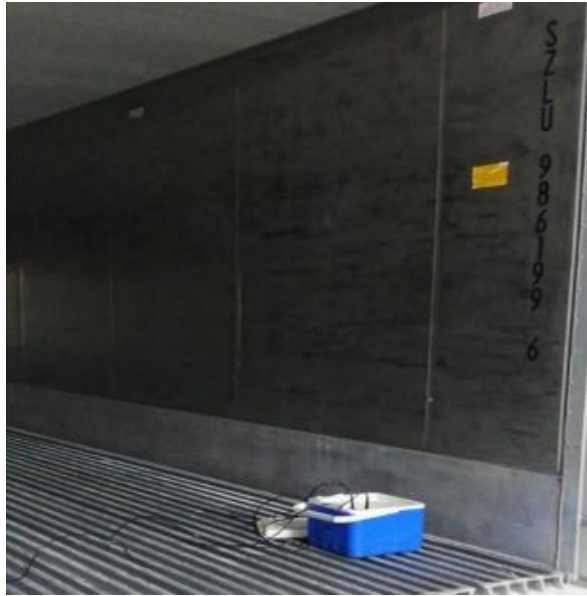
Figura 1: Sensores 1, 2 y 3 con hielo y agua a 0 °C
