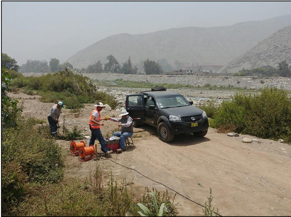
**Figura 26: Sondaje eléctrico vertical – SEV 3**
