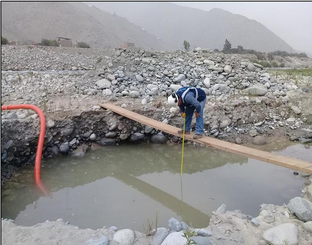
**Figura 33: Medición del nivel dinámico calicata 2**
