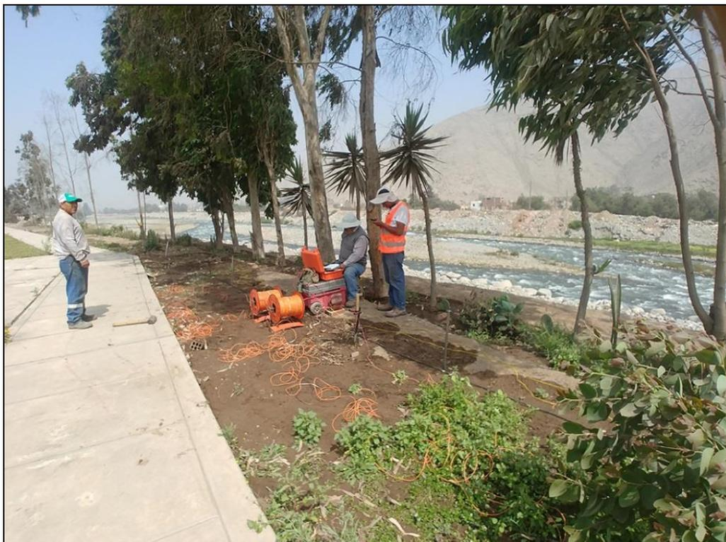
**Figura 29: Sondaje eléctrico vertical – SEV 6**
