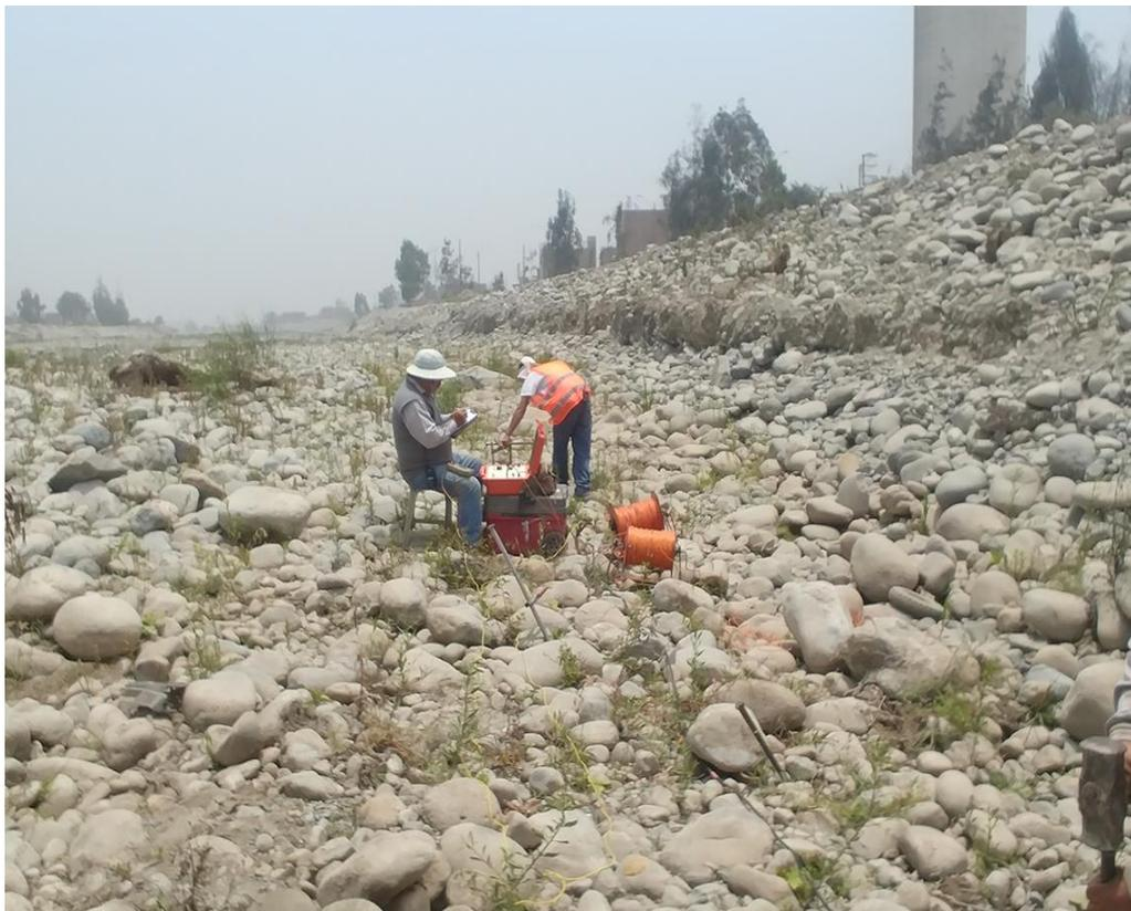
**Figura 27: Sondaje eléctrico vertical – SEV 4**
