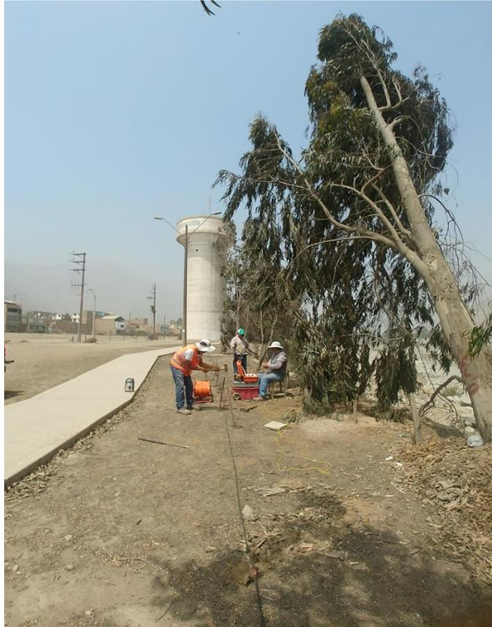
**Figura 28: Sondaje eléctrico vertical – SEV 5**
