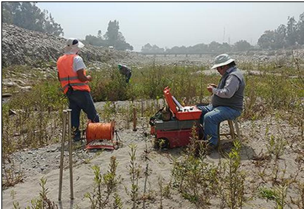
**Figura 25: Sondaje eléctrico vertical – SEV 2**
