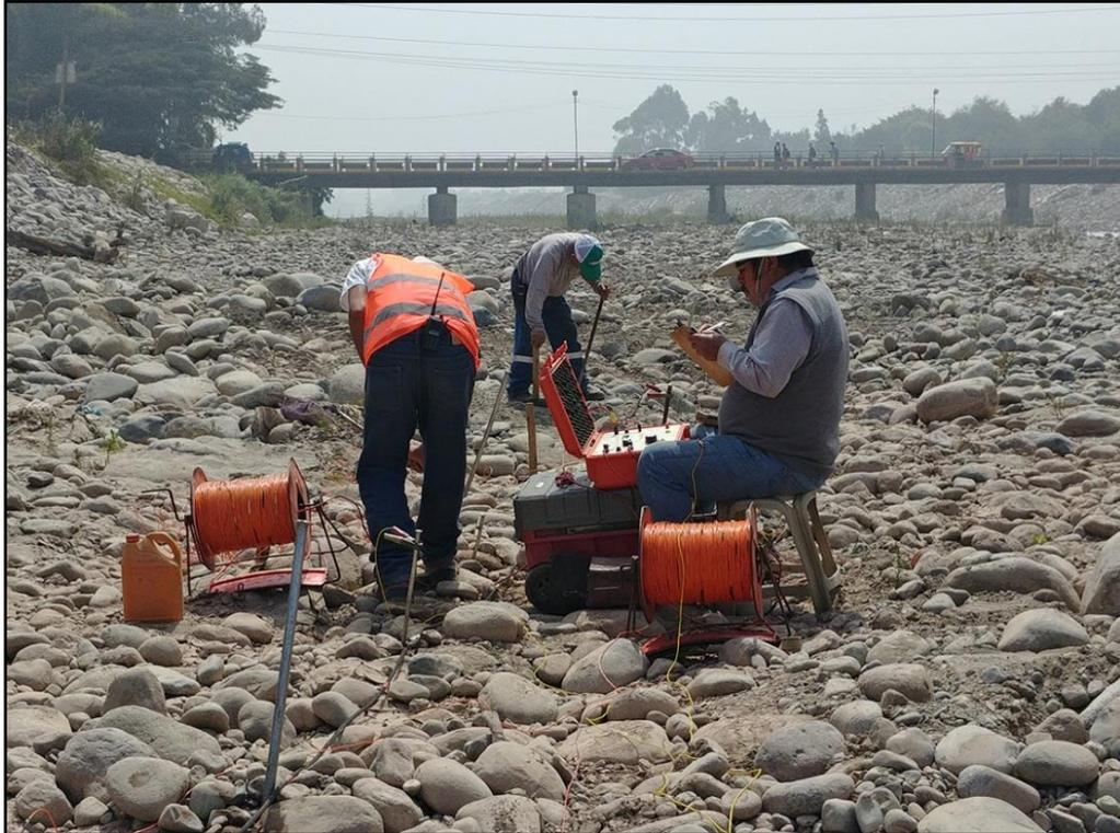
**Figura 24: Sondaje eléctrico vertical – SEV 1**
