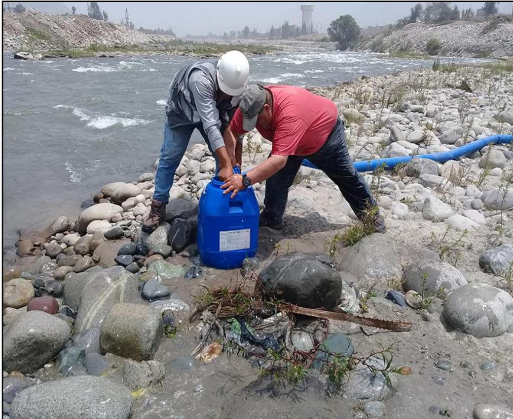
**Figura 31: Aforo del caudal de bombeo en la calicata 1**
