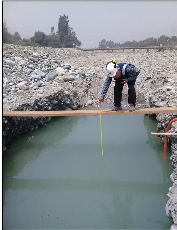
**Figura 30: Medición del nivel dinámico en calicata 1**
