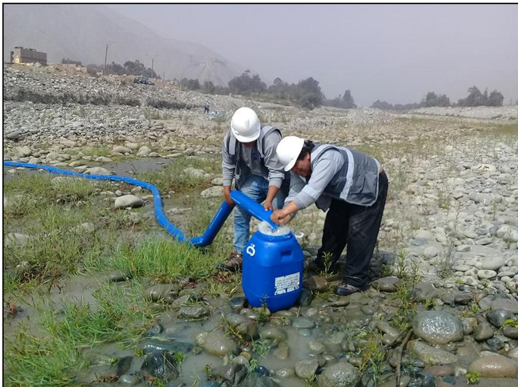
**Figura 35: Aforo del caudal de bombeo en la calicata 3**
