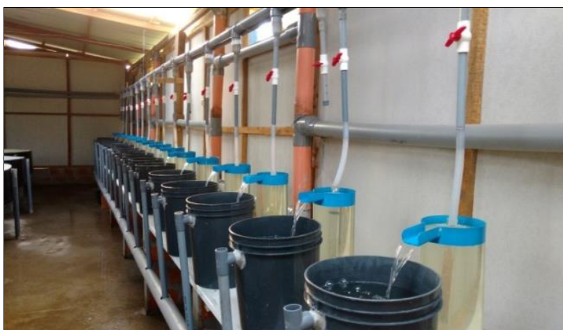
Figura 2. RAS para la incubación de ovas, incubadoras tipo Mc Donald.
