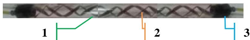
Figura 8: Cámara de desinfección. (1) Tubo de borosilicato, (2) Mezclador estático de acero con TiO 2 , (3) tapón y manguera.
