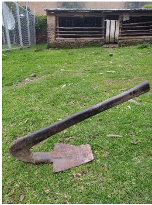
Figura 18. Pala de mango curvo utilizado en los aporques de chacras de maíz FUENTE: Proyecto GEF Abd SIPAM – Maite Oxa
