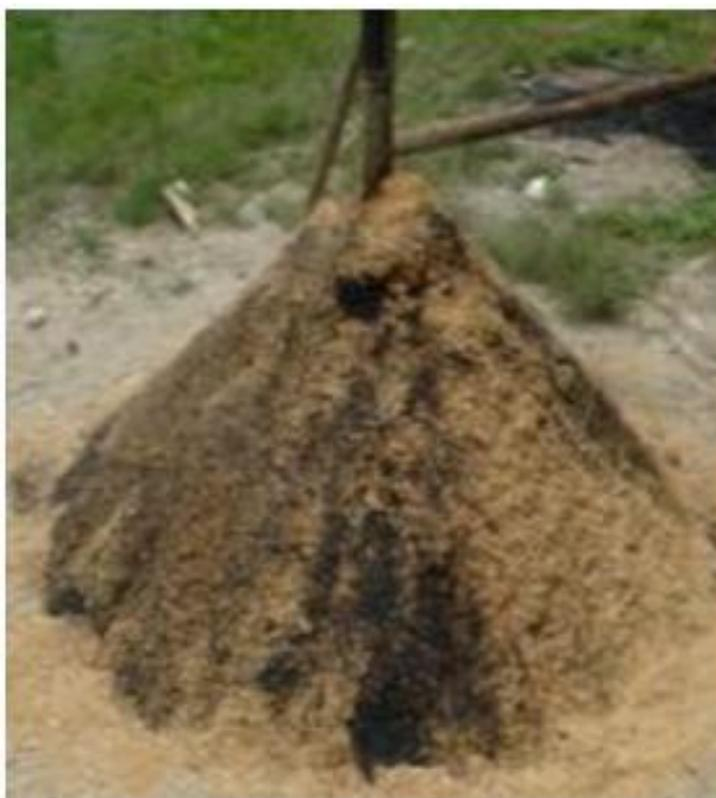
**Figura 8: Proceso de carbonización de sustrato cascarilla**
