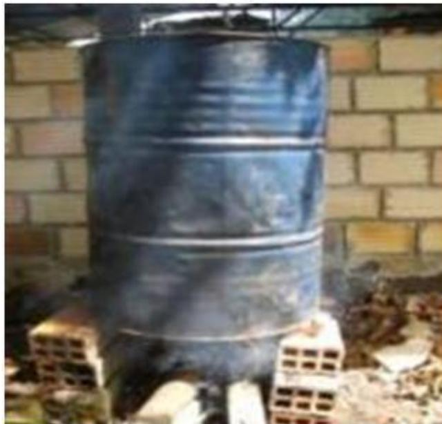
**Figura 11: Hervido a presión (vapor de agua) de sustrato arena gruesa.**
