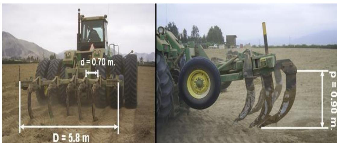
**Figura 19:** Tractor con subsolador ripper
