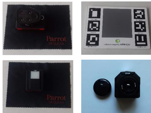
Figura 39: Cámara multiespectral Parrot Sequoia, diana de calibración de al reflectancia y Cámara térmica FLIR.
