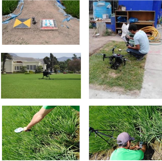
Figura 38: Toma de datos de la RPA para fotografías multiespectrales, toma de datos del Green Seaker para NDVI (imagen inferior izquierda) y del Ceptometro Accupar para IAF (imagen inferior derecha)
