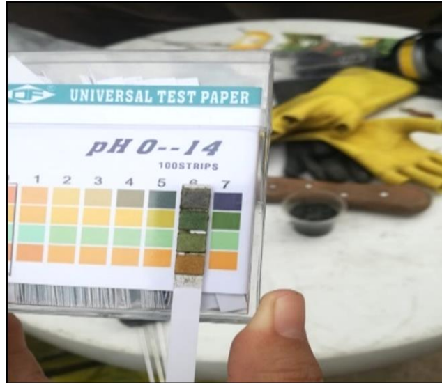
Figura 11. Medición de pH con papel tornasol
