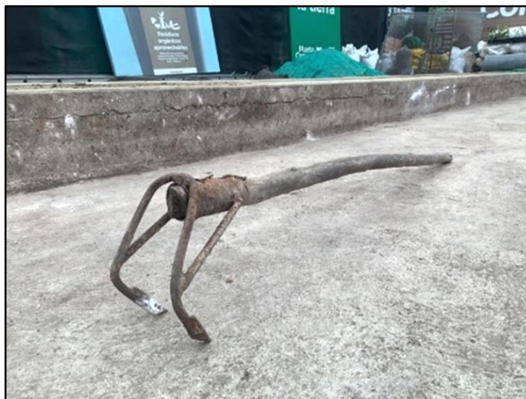
Figura 7. Herramienta zapa para volteo
