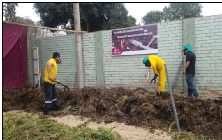
Figura 20. Volteo manual de la pila de compostaje
