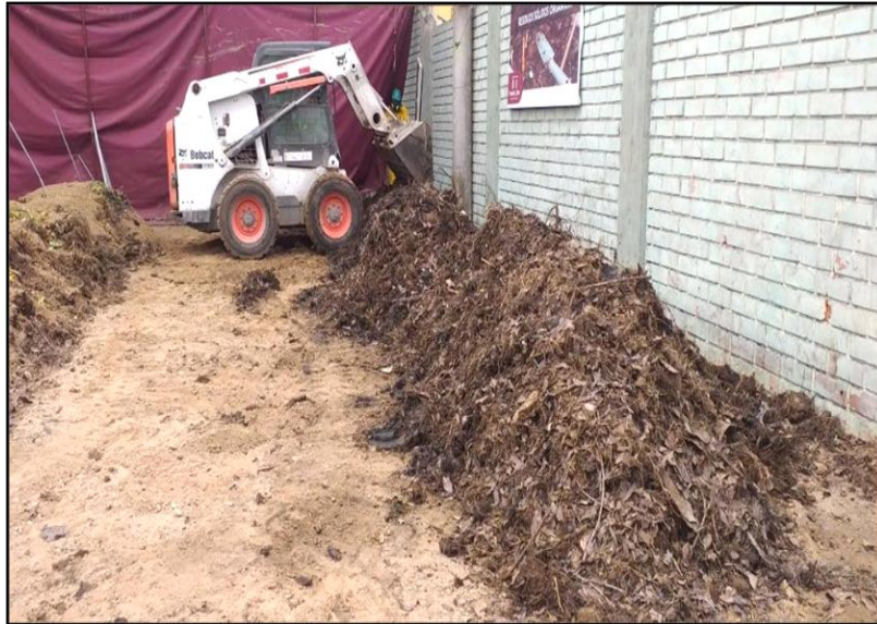
Figura 21. Volteo con minicargador de la pila de compostaje
