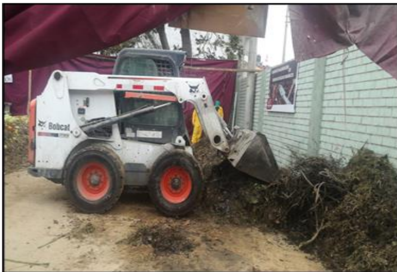
Figura 8. Volteo con minicargador frontal de la pila de compostaje
