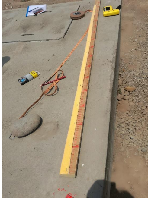
Figura 49. Elaboración de la regla medidora de lodos
