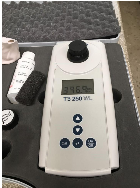
Figura 59. Medición de turbiedad
