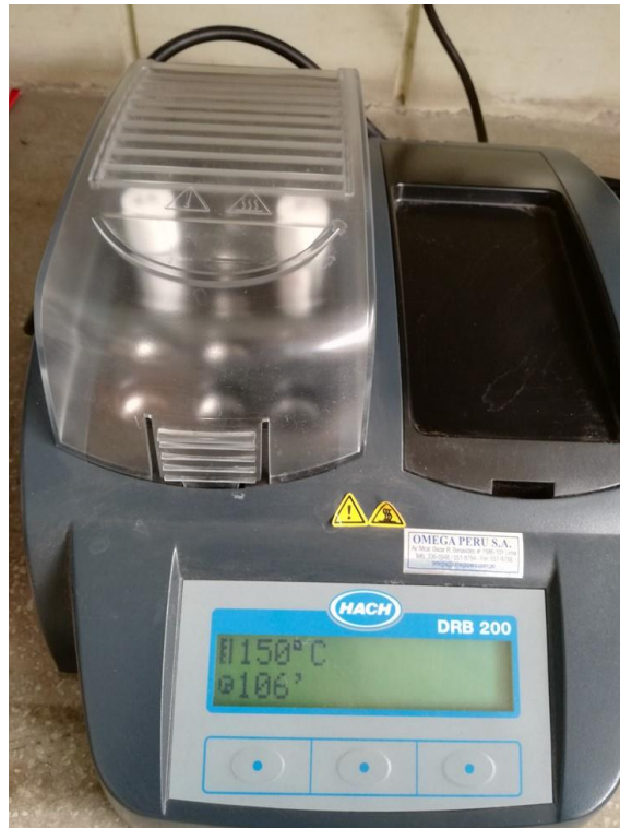
Figura 57. Medición de DQO
