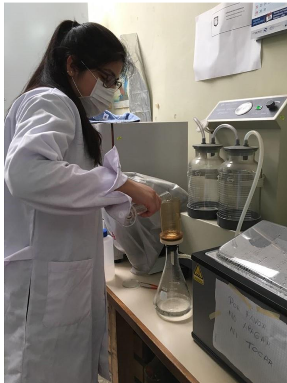
Figura 60. Medición solidos suspendidos
