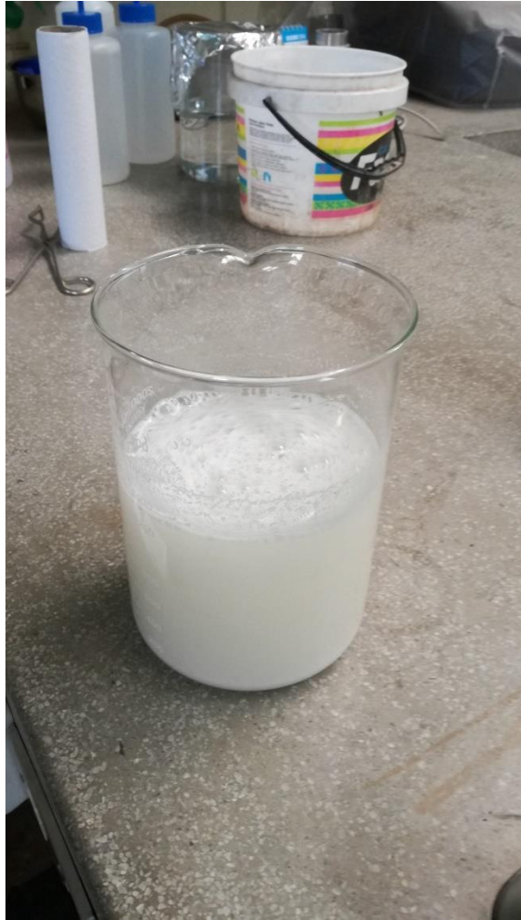
Figura 55. Dilución de CINa en agua destilada
