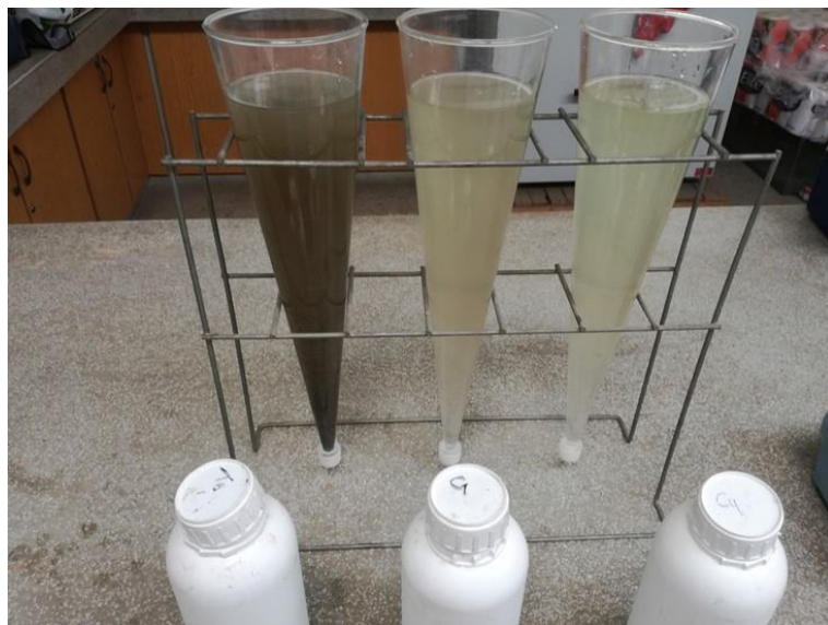
Figura 56. Medición de solidos sedimentables
