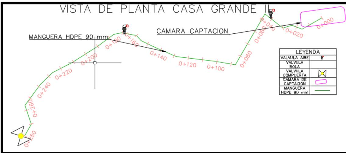
Figura 6: Esquema hidráulico Casagrande II
