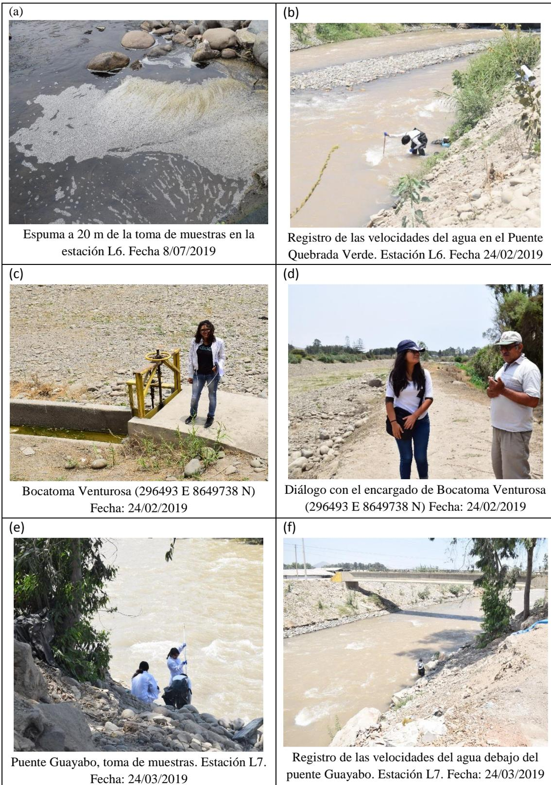
**Figura 53: Fotos desde la estación L6 (puente Quebrada Verde) hasta L7 (puente Guayabo)**
