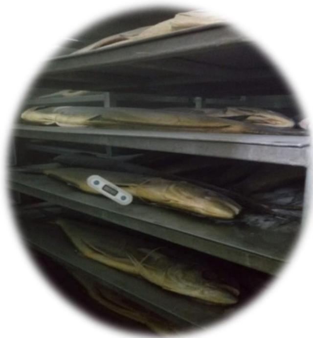
**Figura 6: Medición de la temperatura en el centro del producto al interior del túnel**
