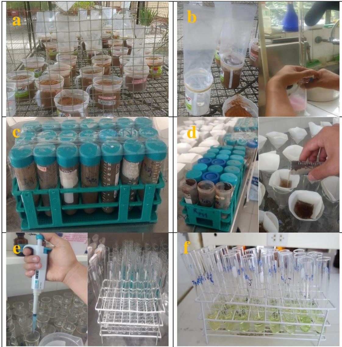
Figura 5: Determinación de la velocidad de mineralización de fuentes orgánicas en laboratorio: a) prueba de incubación en jarras; b) determinación de la tasa de respiración; c) muestreo de suelo para extracción d) extracción y filtrado; e) reacción de desarrollo de color; f) Tubos listos para la lectura de nitrato en el espectrómetro.
