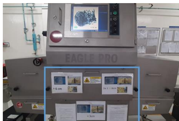
Figura 6. Ubicación en el equipo de las cartillas de clasificación por tamaño de oquedades
