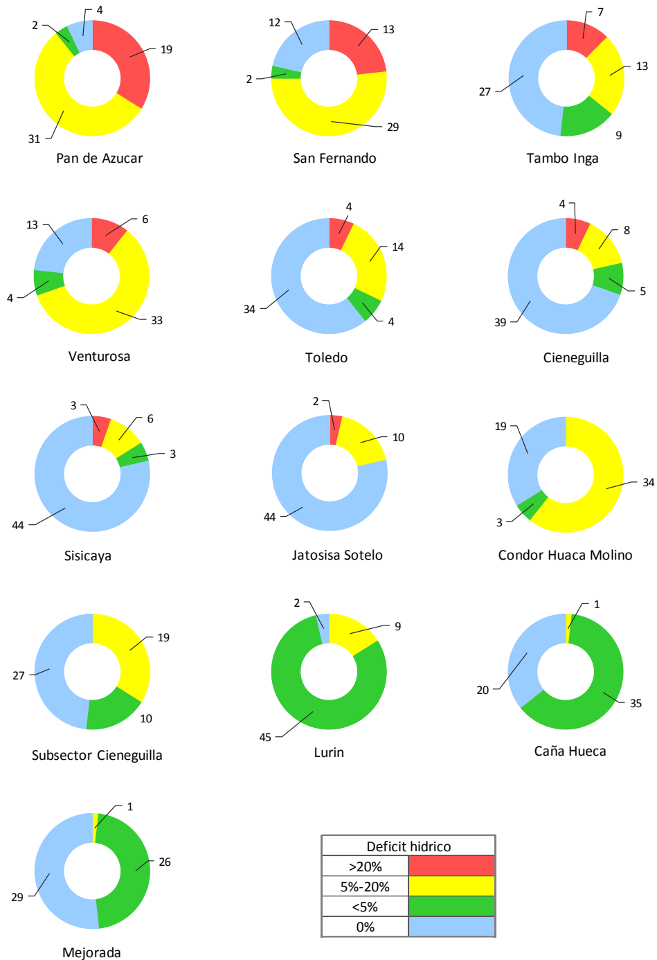
Figura 36: Cantidad de años para cada comisión de regantes de acuerdo a la magnitud de los déficits hídricos producto de la simulación del Escenario 1
