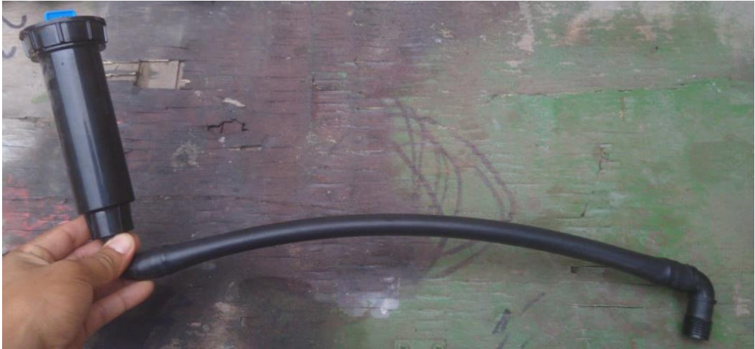
Figura 20: Presentación de la instalación de un rociador de 1/2"
