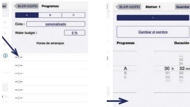
Figura 44: Programación de hora de arranque y duración de riego en aplicación K-RAIN
