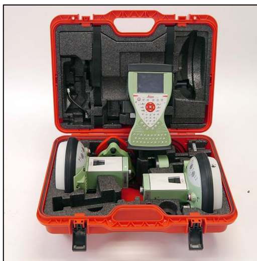
Figura 17: Equipo topográfico utilizado (Gps Leica GS15)
