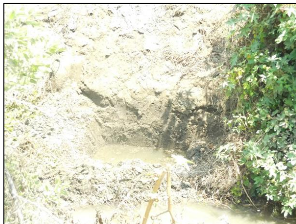
Figura 25: Calicata N° 2, profundidad 0.80m. y ubicado en el Km. 7+326
