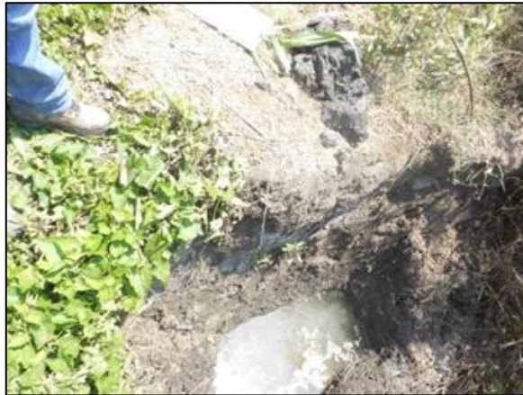
Figura 26: Calicata N° 3, profundidad 1.50 m. y ubicado en el Km. 7+947
