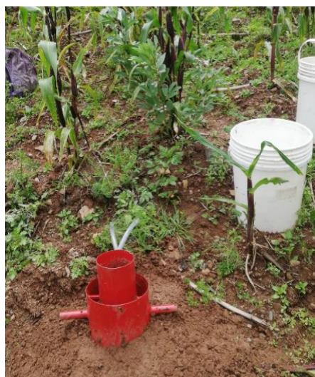
Figura 8: Prueba de infiltración
