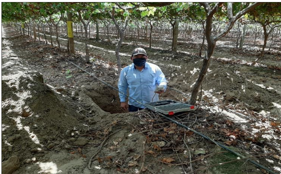
Figura 22: Medición de humedad del suelo con el Wet sensor.
