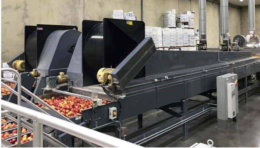
Figura 6. Operación unitaria de secado por túnel
