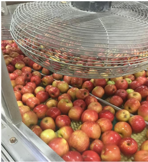
Figura 4. Operación unitaria de secado por ventiladores
