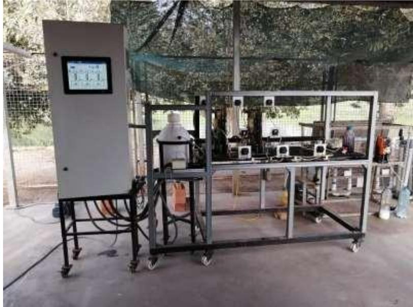
**Figura 12: Sub sistema reactor de iones ferrato (VI)**
