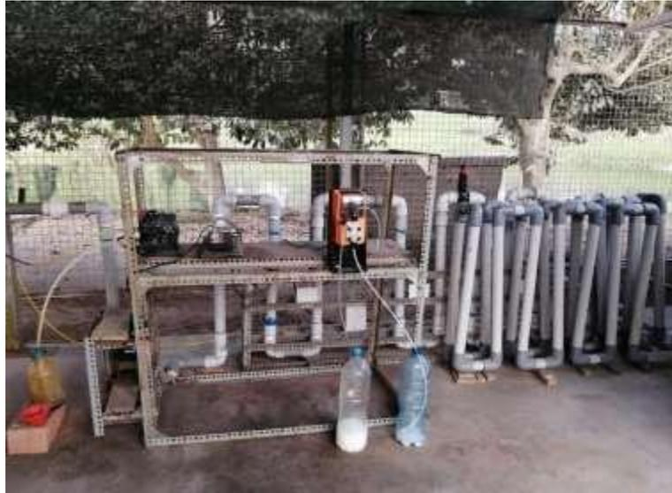
**Figura 13: Subsistema de control de pH**
