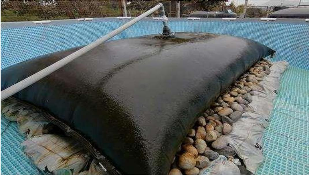
**Figura 9: Bolsa geotubo en operación**
