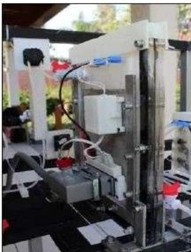
**Figura 1: Reactor de iones ferrato (VI)**
