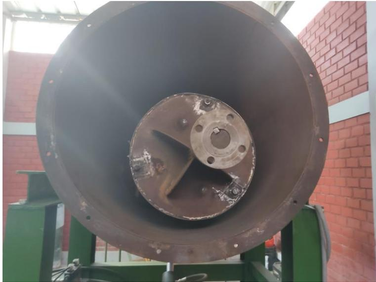
**Anexo 14:** Estructura de conexión entre el tambor del molino y el motor
