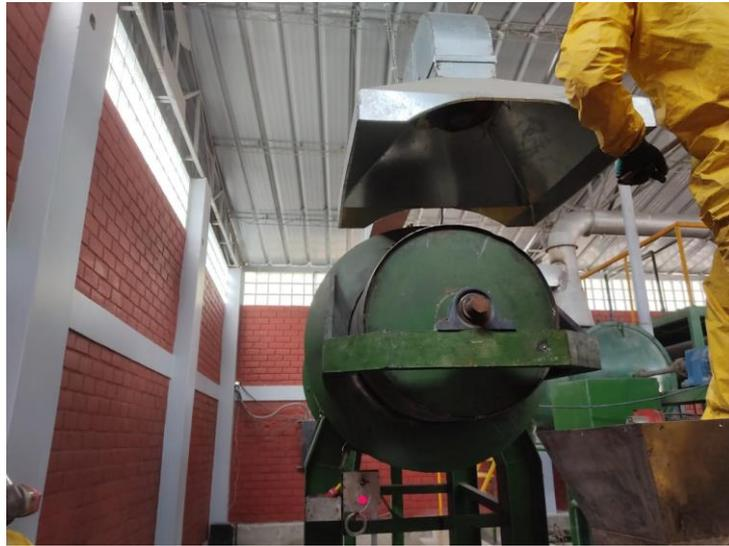
**Anexo 20:** Condensador de gases
