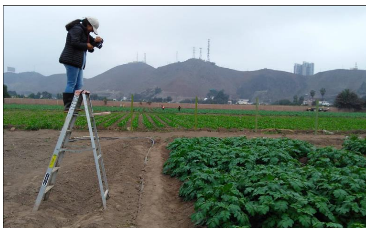
Figura 11: Se observa la toma de imágenes térmicas del follaje del cultivo de la papa mediante la cámara FLIR E60.
