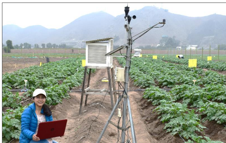
Figura 9: Estación meteorológica (HOBO U30, Onset Computer Corporation, Bourne, USA).
