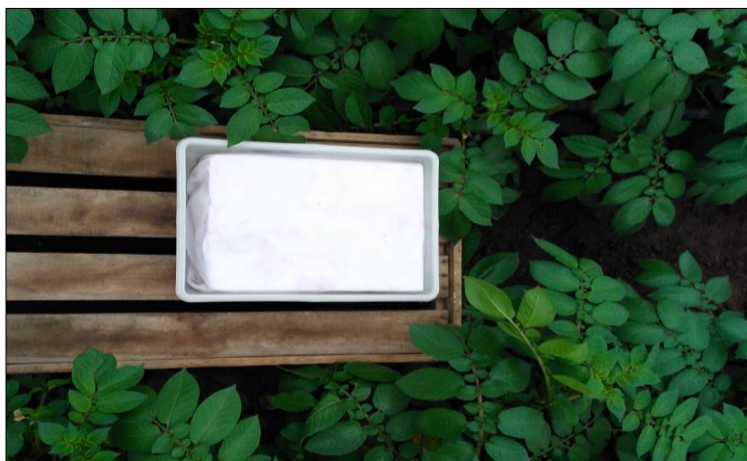
Figura 10: Superficie de referencia artificial húmeda ( SRAH ).
