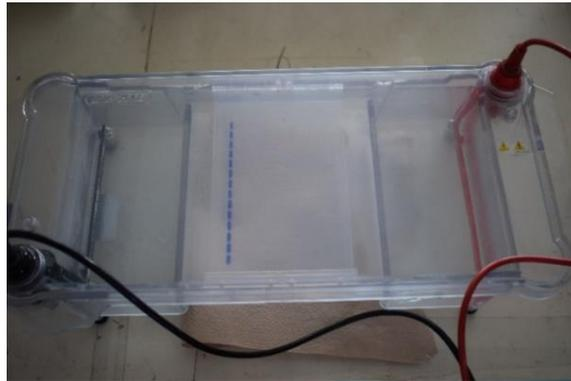
**Figura 9. Electroforesis en gel de agarosa al 2%**
