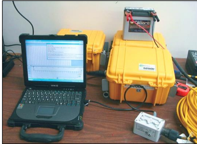
Figura 24: Ensayo de refracción sísmica – Geode y equipo de computo para la interpretación de datos
