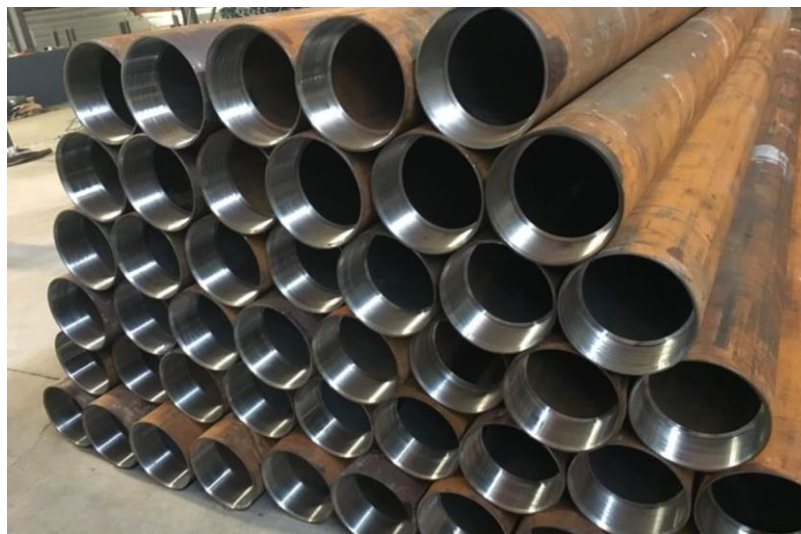
Figura 41: Tuberías de revestimiento
