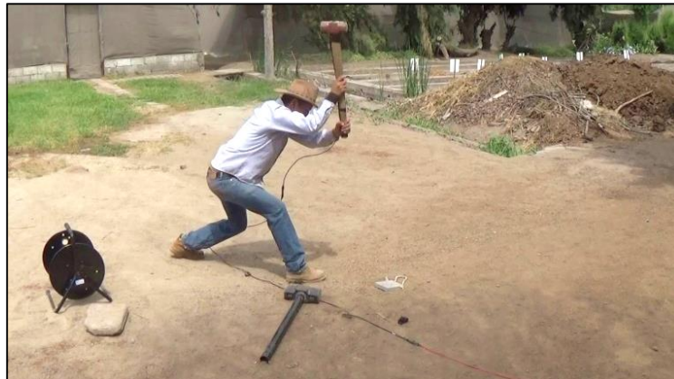
Figura 21: Ensayo de refracción sísmica - generación de ondas
