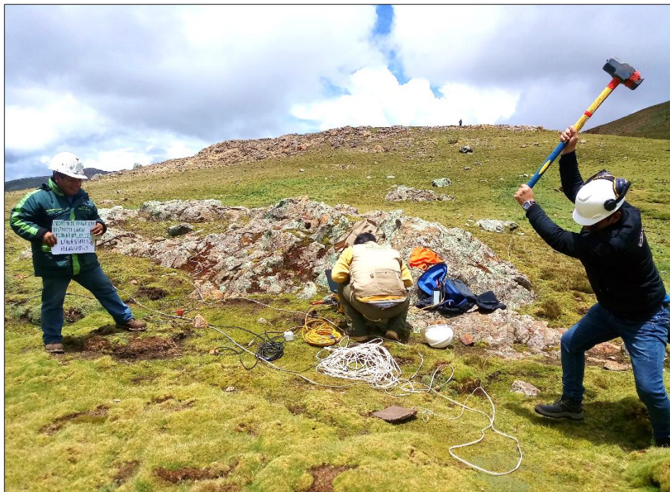
Figura 52: Punto inicial para la realización del ensayo de refracción sísmica 01
