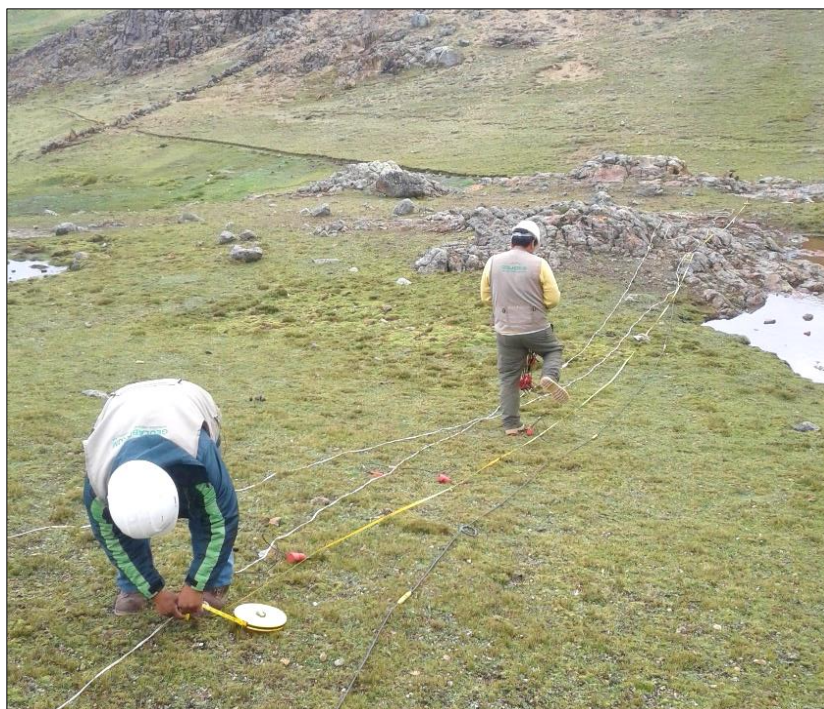
Figura 53: Tendido de geófonos para el ensayo de refracción sísmica 01
