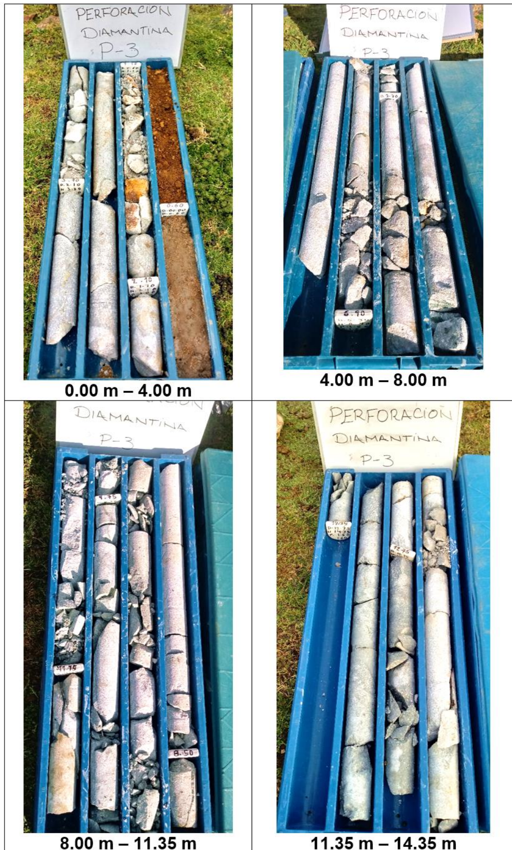
Figura 68: Punto de perforación P-3. Muestreo de primeros 14.35 metros del subsuelo
