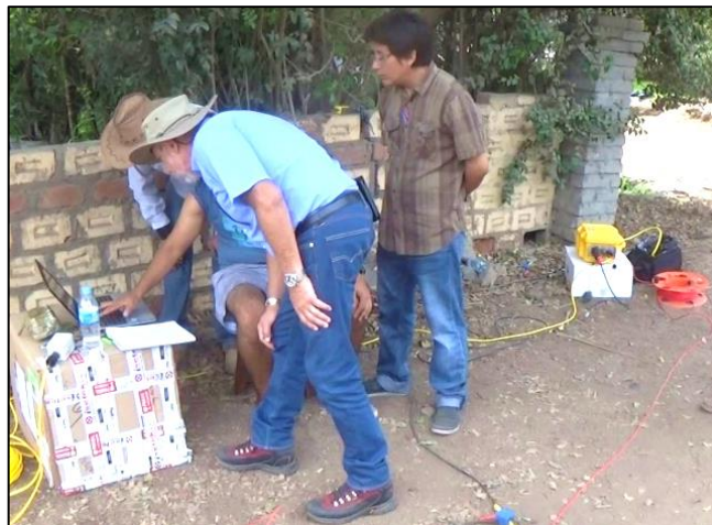
Figura 23: Ensayo de refracción sísmica - equipo de acopio y almacenamiento
