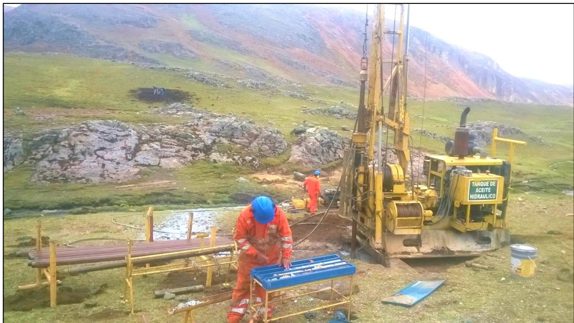
Figura 59: Punto de perforación P1. Colocando las muestras en caja porta testigo
