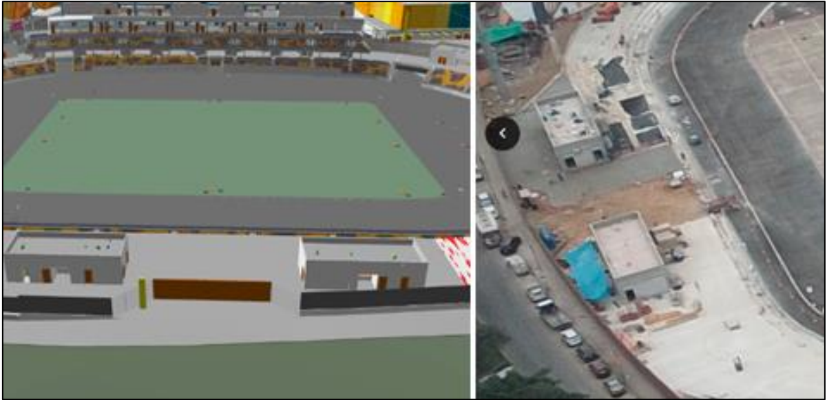
Figura 67: Comparación de las herramientas BIM y fotografías a tiempo real con el avance de obra en sector2 fase2
