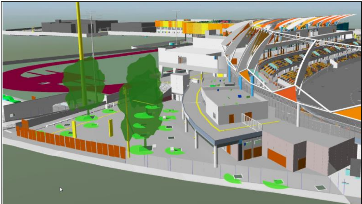
Figura 64: Uso de la herramienta BIM para la identificación y liberación de frentes de trabajo en el sector 2
