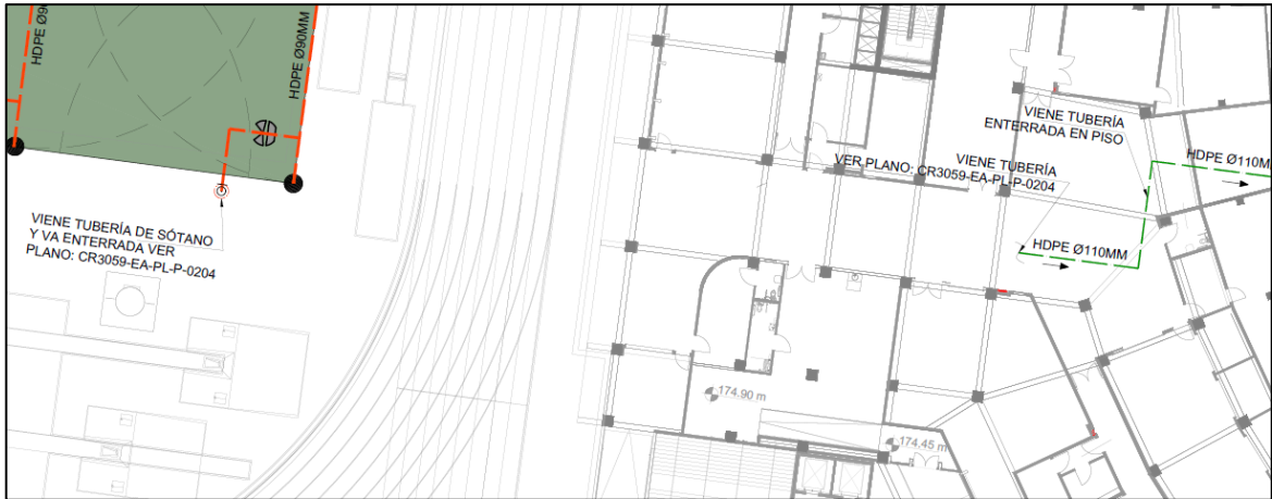
Figura 52: Plano de pases de tuberías de riego, Plano CR3059-EA-PL-P-0202
