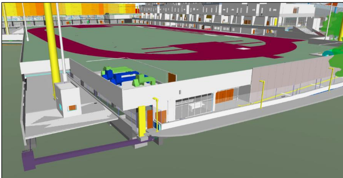
Figura 62: Uso de la herramienta BIM para la identificación y liberación de frentes de trabajo en el sector 2 fase 2
