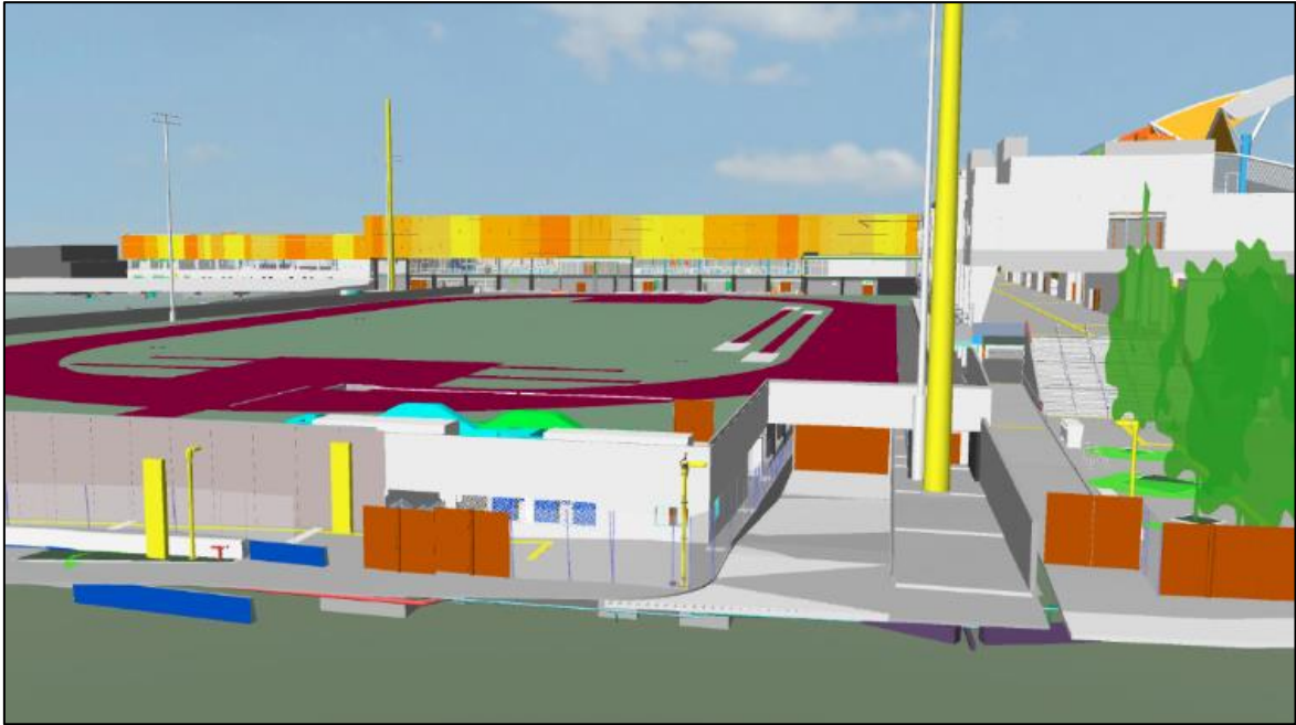
Figura 63: Uso de la herramienta BIM para la identificación y liberación de frentes de trabajo en el sector 2 fase 2
