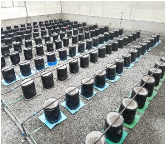
Inicio del riego de machaco
