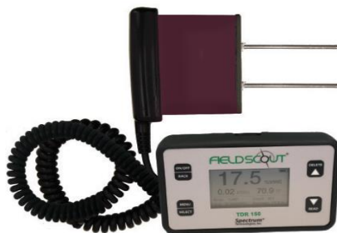
Figura 3: TDR modelo 150 FieldScout
