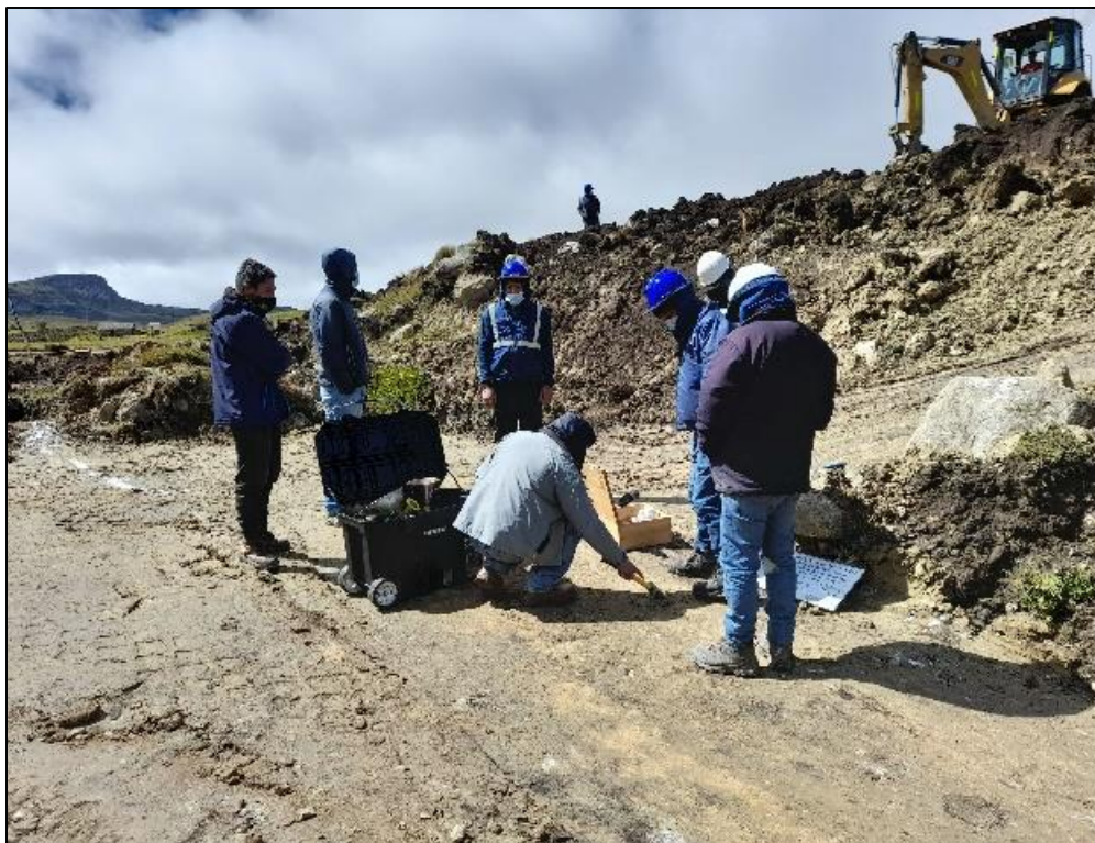
Figura 30: Pruebas de densidad de campo – capa media
