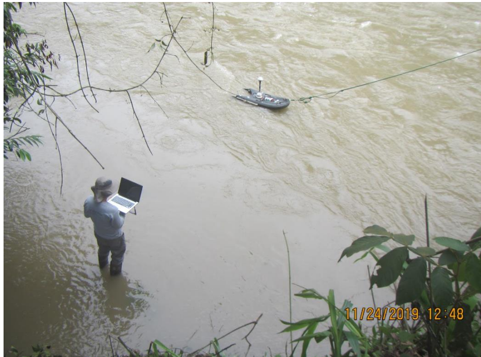
Figura 32: Toma de datos en tiempo real con equipo batimétrico ADCP S5
