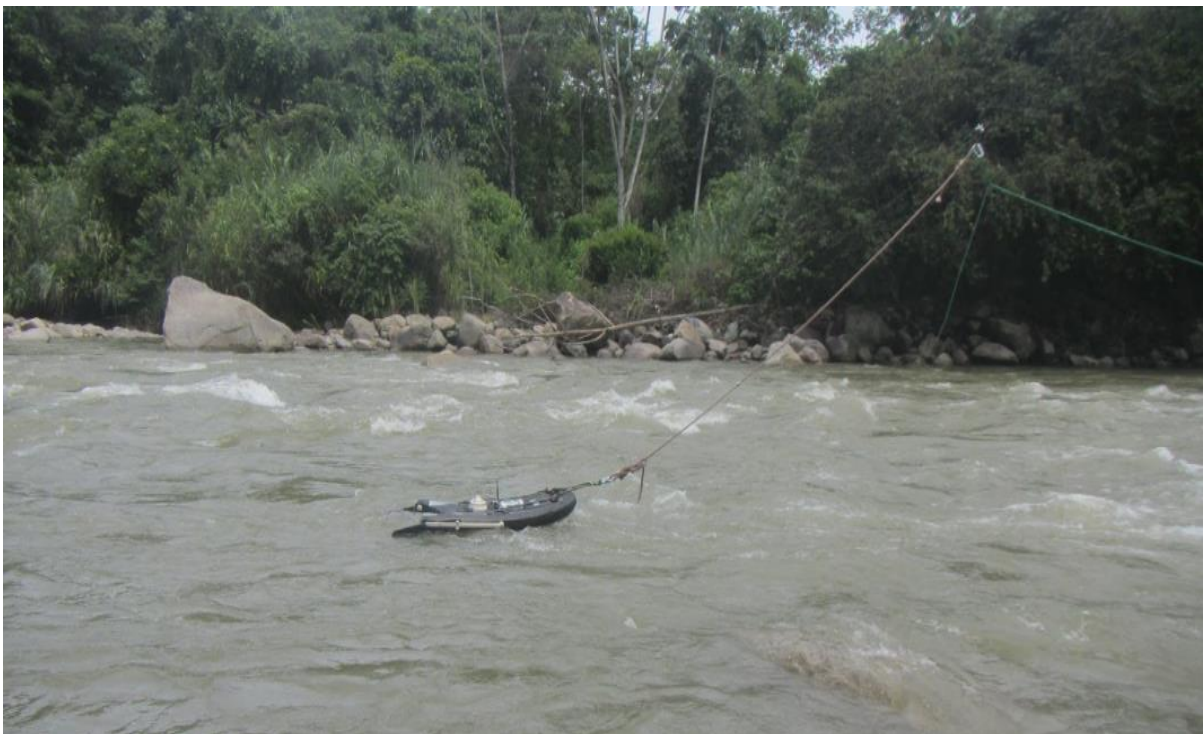
Figura 20: Operación del equipo ADCP de batimetría (Vista 2)
