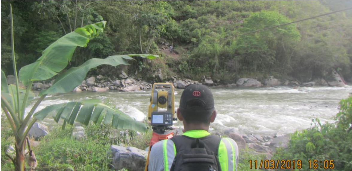
Figura 10: Equipo topográfico, estación total utilizada en el levantamientos topográfico de transectos
