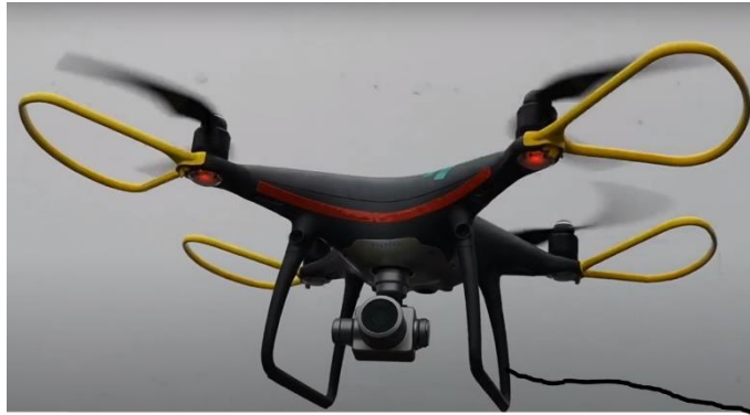
Figura 13: Uso del dron en el traslado de un hilo a lo largo del transecto
