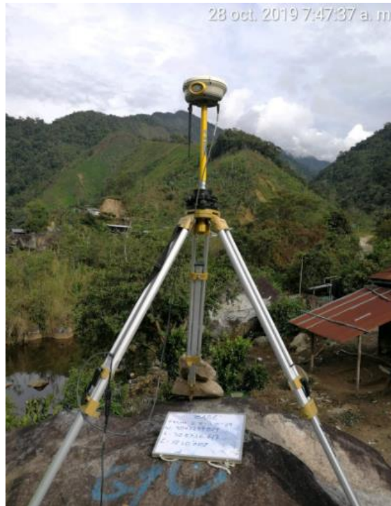
Figura 8: Posicionamiento del GNSS TRIMBLE R8
