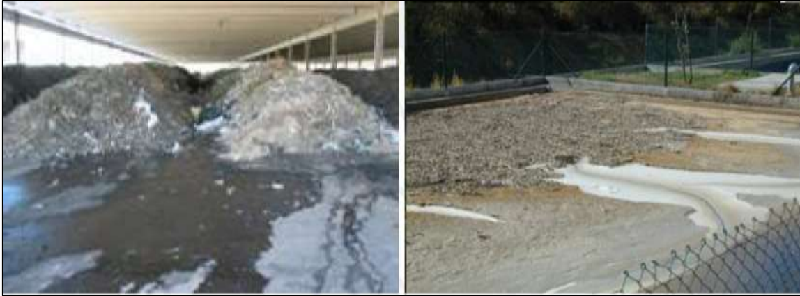
Figura 6: Generación de lixiviado en pilas de compostaje
