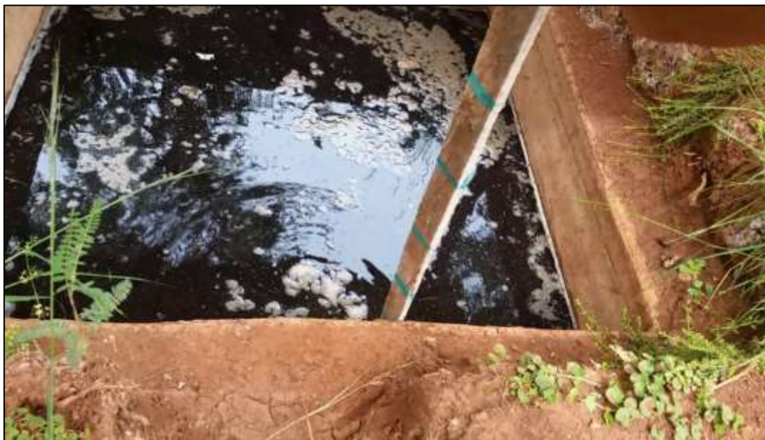
Figura 16: Medición del volumen de lixiviado de compostaje en la caja de almacenamiento del relleno sanitario de Chacán – Anta.
