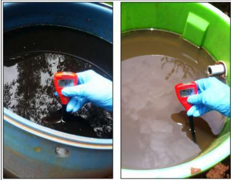
Anexo 1.7. Medición de pH al ingreso del piloto (izquierda) y del efluente de humedal horizontal (derecha)
