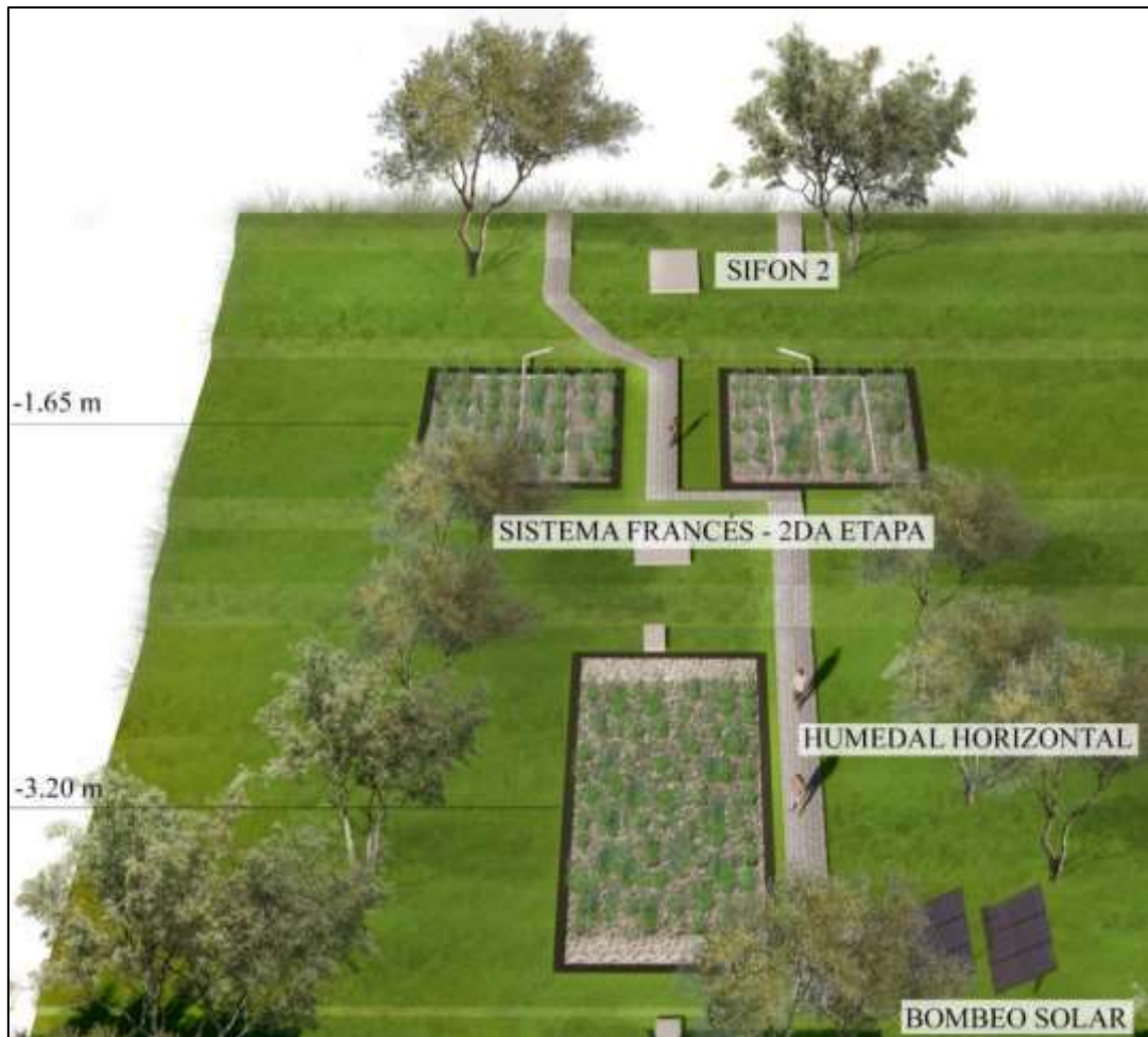
Figura 48: Vista de segunda etapa de Sistema Francés y humedal horizontal
