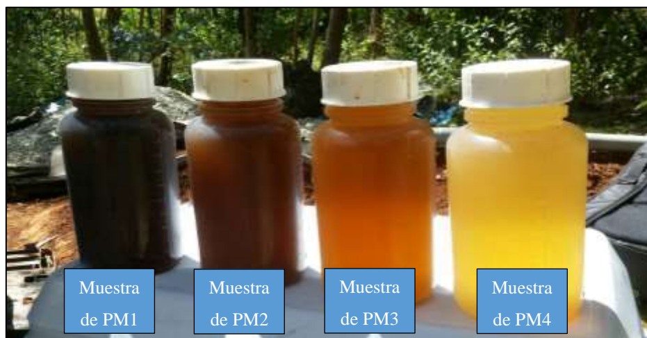
Figura 39: Muestra de lixiviado afluyente y de efluentes de humedales
