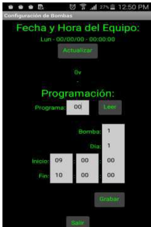
Anexo 1.5. Interfaz del software de bombeo del piloto de humedales
