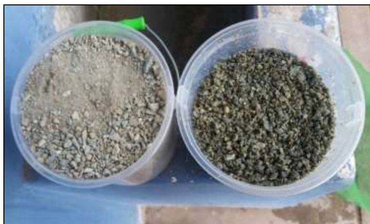
Figura 18: A la izquierda confitillo y a la derecha confitillo zarandeado y lavado
