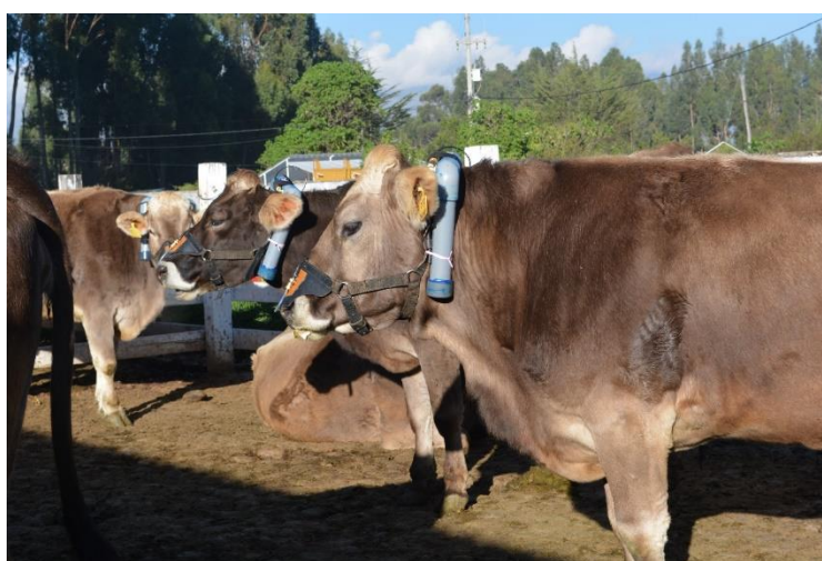
Figura 8. Sistema de colección de gas expirado en los animales
