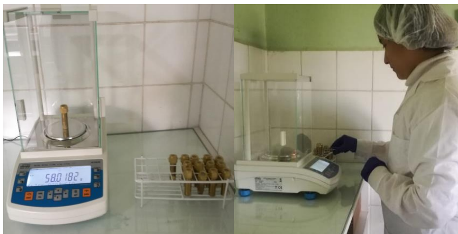
Figura 6. Pesaje de capsulas de permeación.
