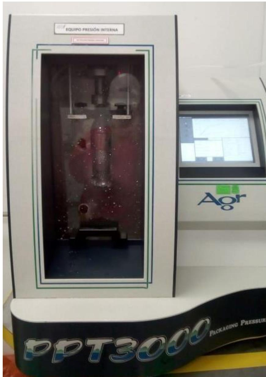
Figura 16: Equipo PPT3000 para realizar presión interna.
