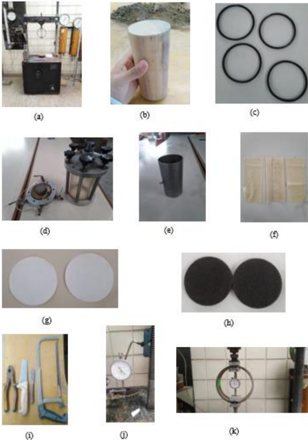
Figura 101: (a)Máquina de compresión Triaxial, (b) Molde cilíndrico, (c)Anillos de seguridad de jebe, (d)Cámara de compresión triaxial, (e)Equipo para colocar la membrana en la probeta de suelo, (f) Membranas para probetas de 4" de diámetro, (g) Papel filtro, (h) Discos porosos, (i) Alicates, cuchillas y sierra de hoja, (j) Deformímetro, (k) Anillo de carga
