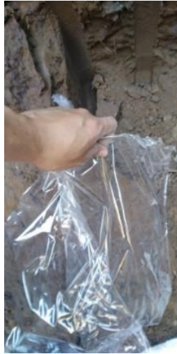
Figura 52: Utilización de rollo film para conservar las características in-situ del bloque grande inalterado de suelo y su sentido de estratificación
