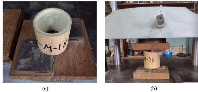
Figura 81: (a) Ubicación de la probeta en el implemento para el ensayo de corte. (b) Colocación de la probeta con el implemento para el ensayo de corte en la máquina
