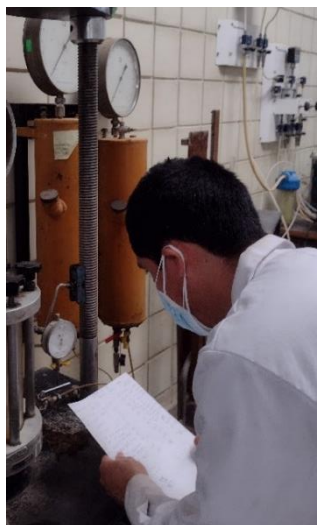
Figura 63: Medición de la variación de la altura de la probeta después de la aplicación de la presión de confinamiento
