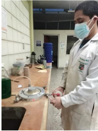
Figura 54: Verificación de obstrucciones en los conductos de la cámara de compresión triaxial
