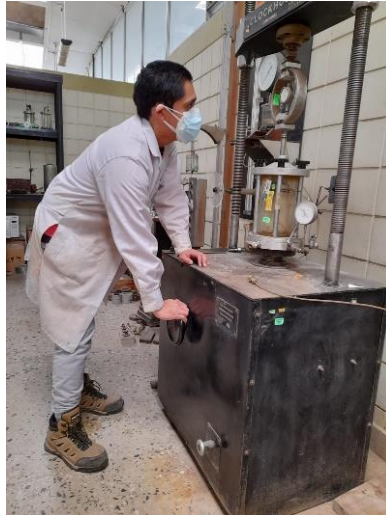
Figura 59: Elevación y ajuste de la cámara de confinamiento en la máquina para compresión triaxial
