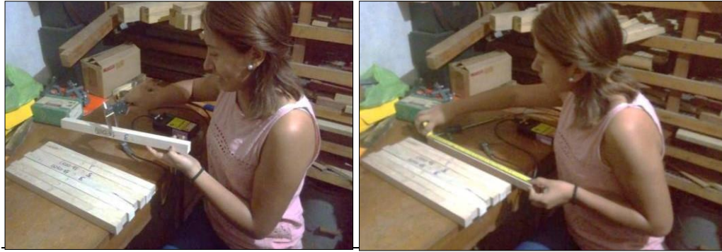
Fig. 9: Medición de ancho y espesor (izquierda) , longitud (derecha) de las probetas para flexión
