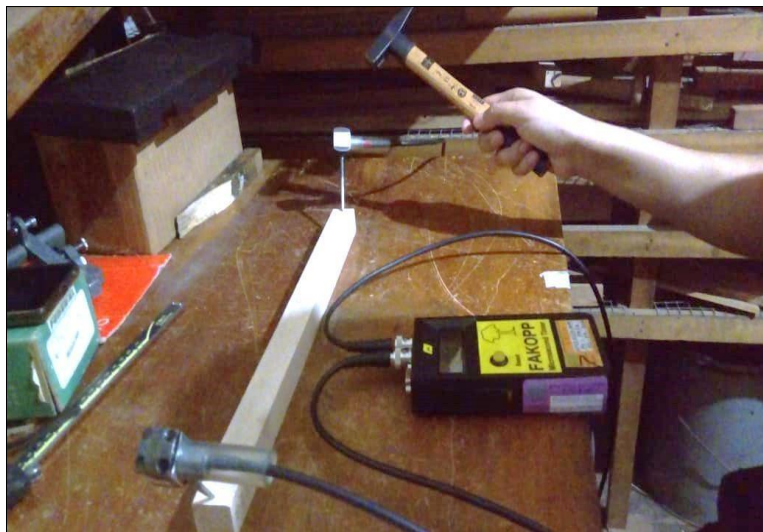
Fig. 10: Lectura de tiempo de propagación de onda en el Microsecond Timer
