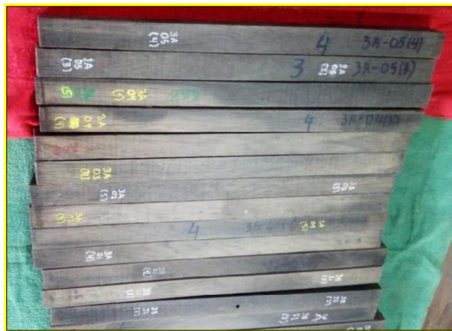
Fig. 8: Probetas de flexión en condición saturada
