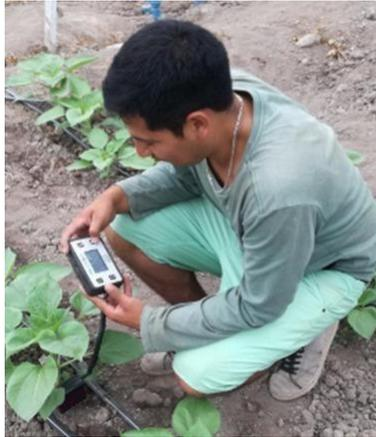
**Figura 12: Toma de muestra de humedad del suelo del cultivo de girasol.**
