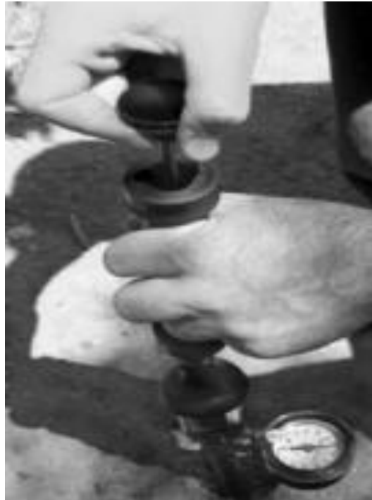
Figura 3: Uso de bomba de vacío en tensiómetro instalado en campo
