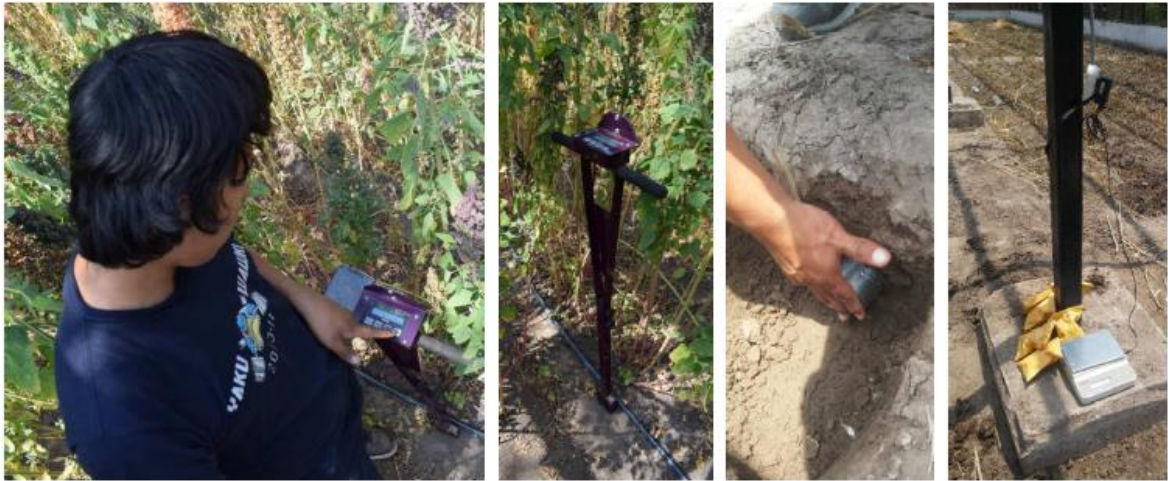
Figura 25: Toma de datos de humedad volumétrica con el medidor TDR-300 Field Scout
