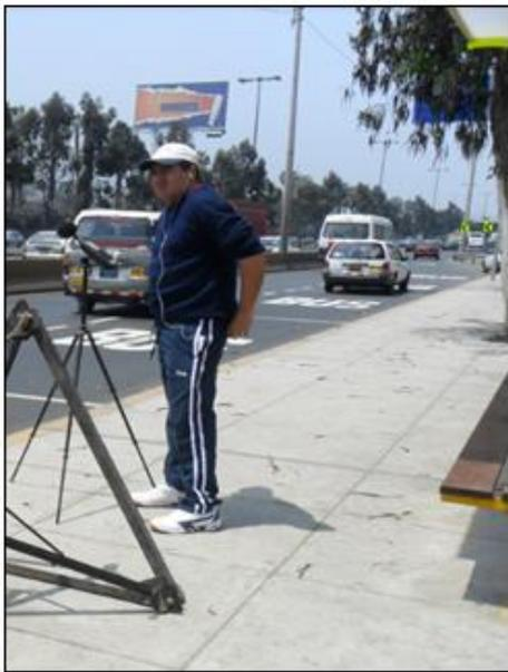
**Figura 32: Medición de ruido ambiental a diferentes alturas.**
