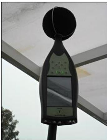
Figura 3: Equipo de medición de ruido: sonómetro.
