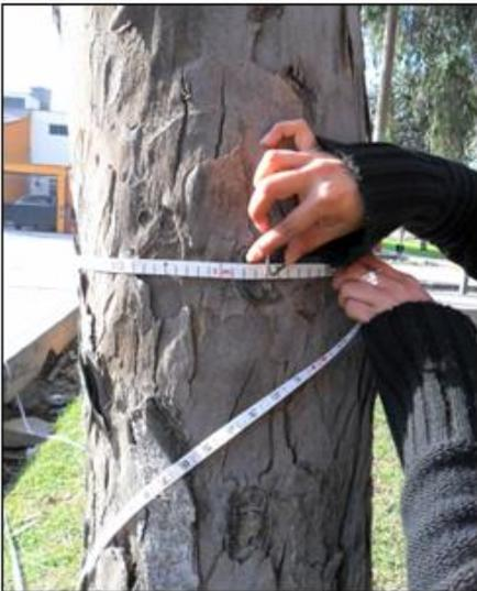
**Figura 31: Medición de diámetro a la altura del pecho (DAP).**
