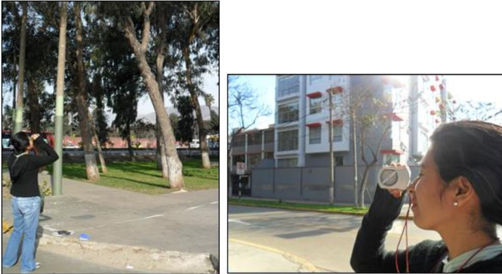
**Figura 30: Medición de altura total (HT), altura de fuste (HF) y altura de copa (HC).**
