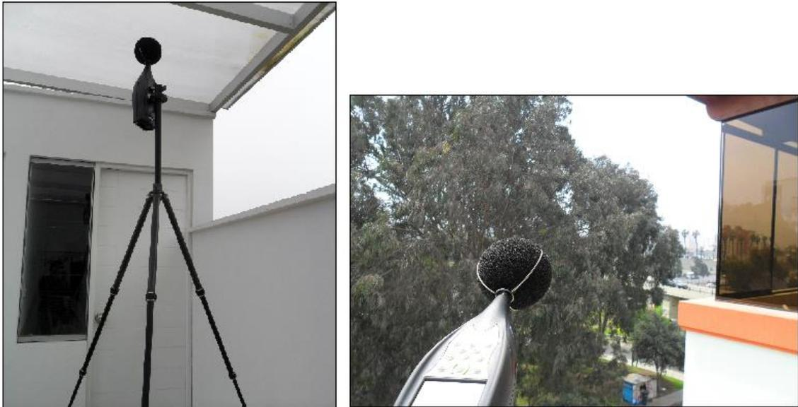
**Figura 33: Medición de ruido ambiental en azoteas de los edificios.**
