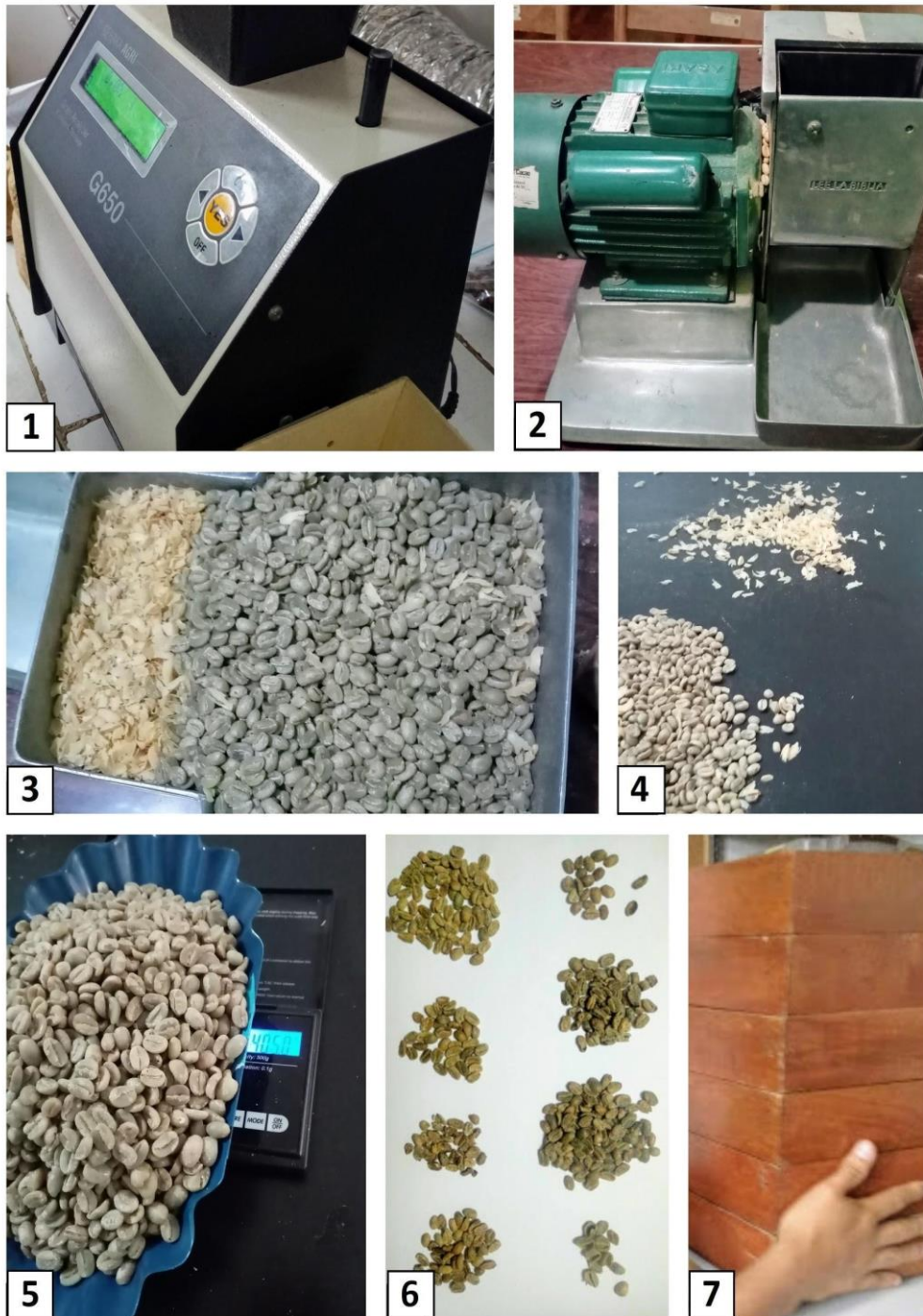
Figura 2. Prueba de calidad física. (1) Medidor de humedad, (2) Trilladora, (3) Café oro y cascarilla luego del trillado, (4) Separación de café oro y cascarilla, (5) Peso de café oro, (6) Separación y clasificación de granos defectuosos, (7) Zarandeo de café oro
