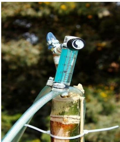
Figura 30: Ajuste del flujo de H_2S , biogás
