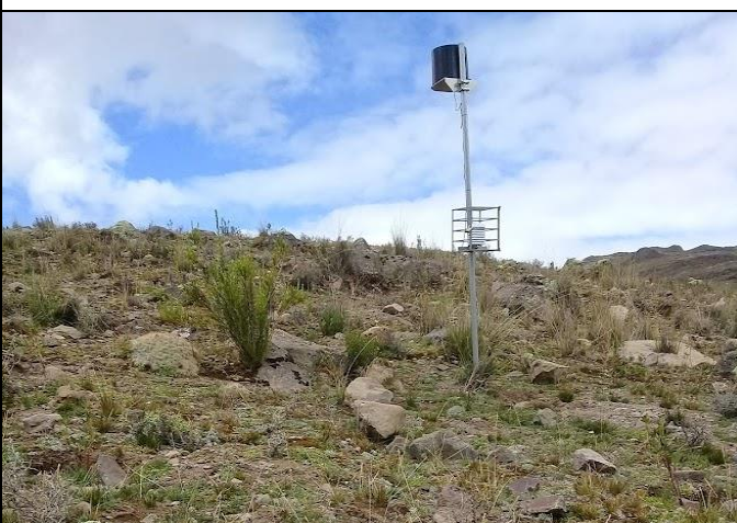
Fotografía 12. Microestación WatchDog Spectrum para el registro de datos meteorológicos SH-E1.
