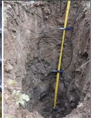
Fotografía 2. Microestación WatchDog Spectrum y sensores de humedad del suelo WaterScout SM100 .
