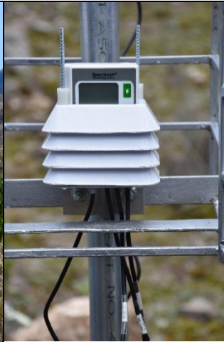
Fotografía 2. Microestación WatchDog Spectrum y sensores de humedad del suelo WaterScout SM100 .
