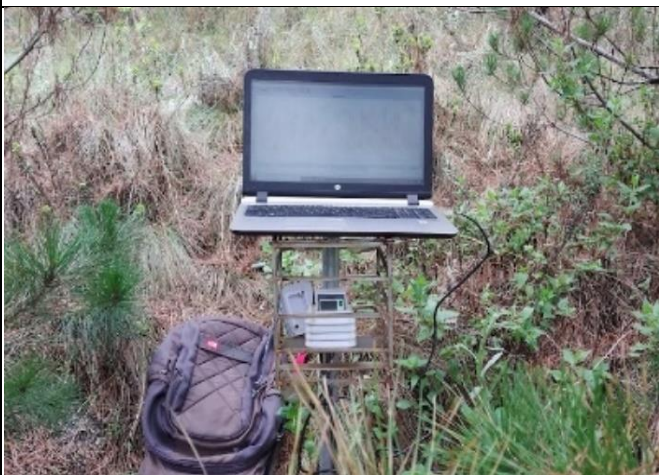
Fotografía 5. Microestación para registro de humedad del suelo del punto de evaluación TY-03.
