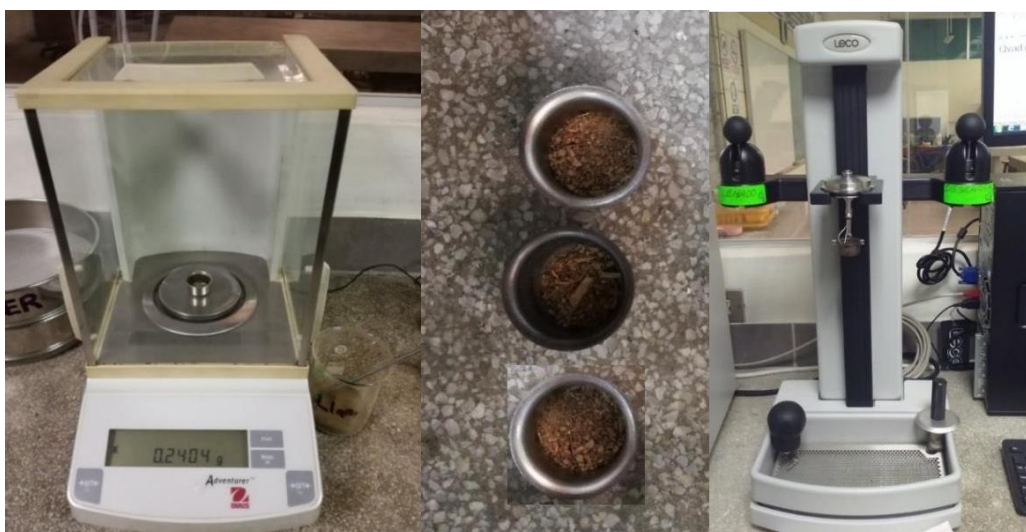
Figura 46: Procedimiento de pesado de la muestra por triplicado y colocación del hilo de algodón.
