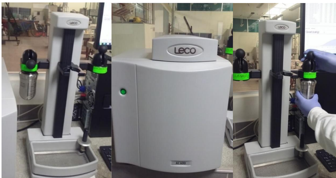
Figura 47: Llenado y descarga de oxígeno en la bomba calorimétrica para análisis en el equipo calorímetro AC600.
