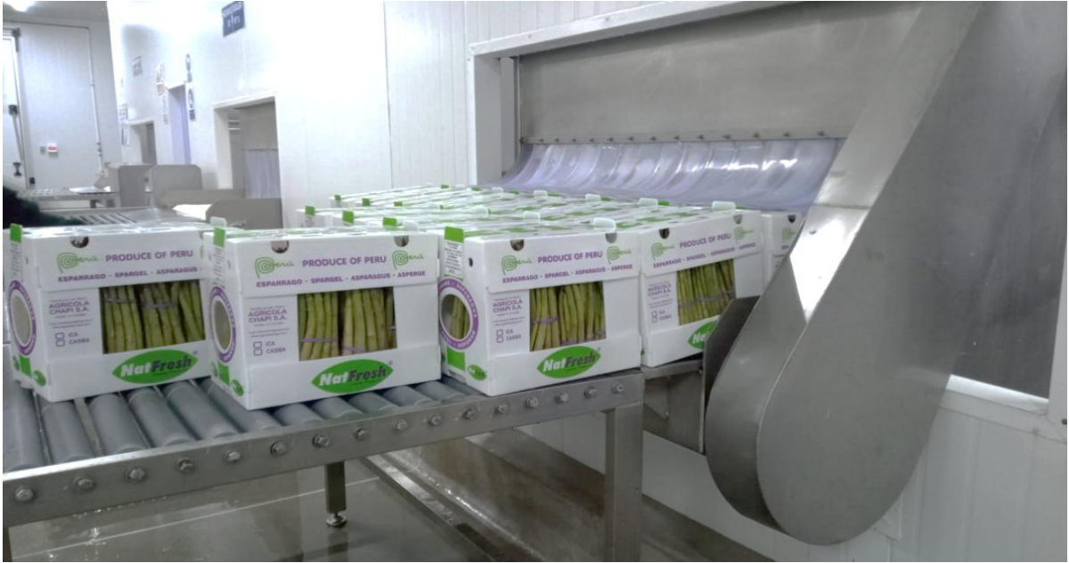
Figura 23. Salida del producto terminado por el hidrogenfriador 2.
