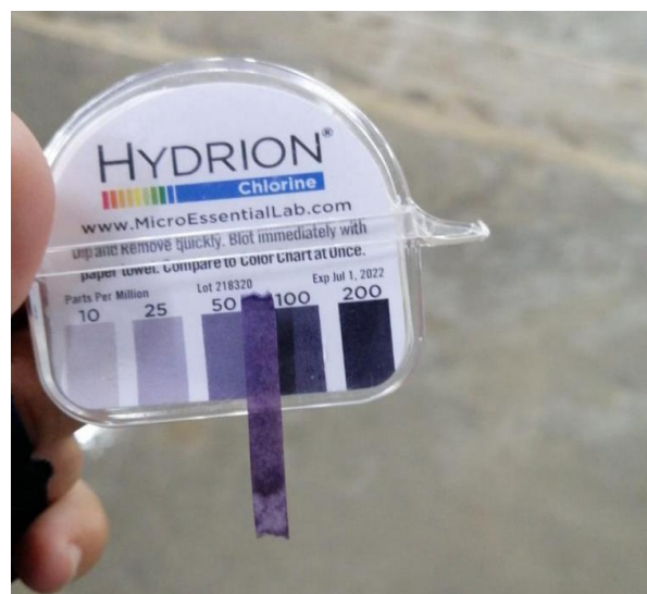
Figura 15. Verificación de la concentración del hipoclorito de sodio.
