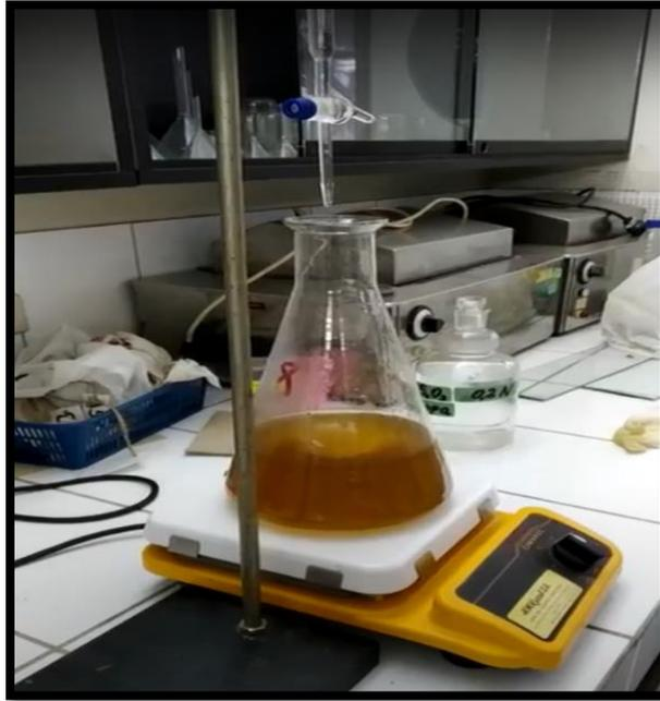
**Figura 28.** Ensayo Kappa para determinar el contenido de lignina residual
