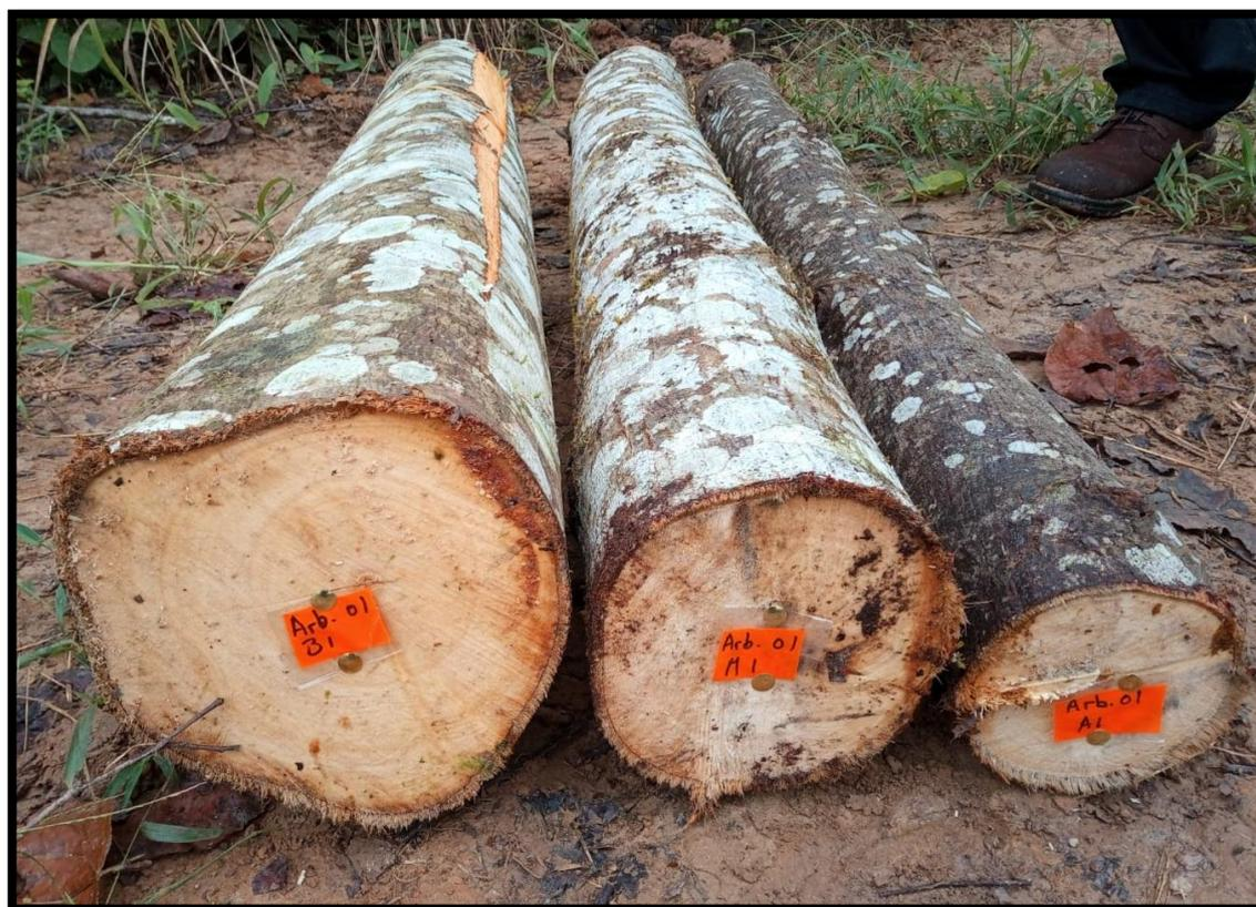
**Figura 16.** Trozas correspondientes a las secciones de interés (Sección: basal, media y alta) del árbol 1
