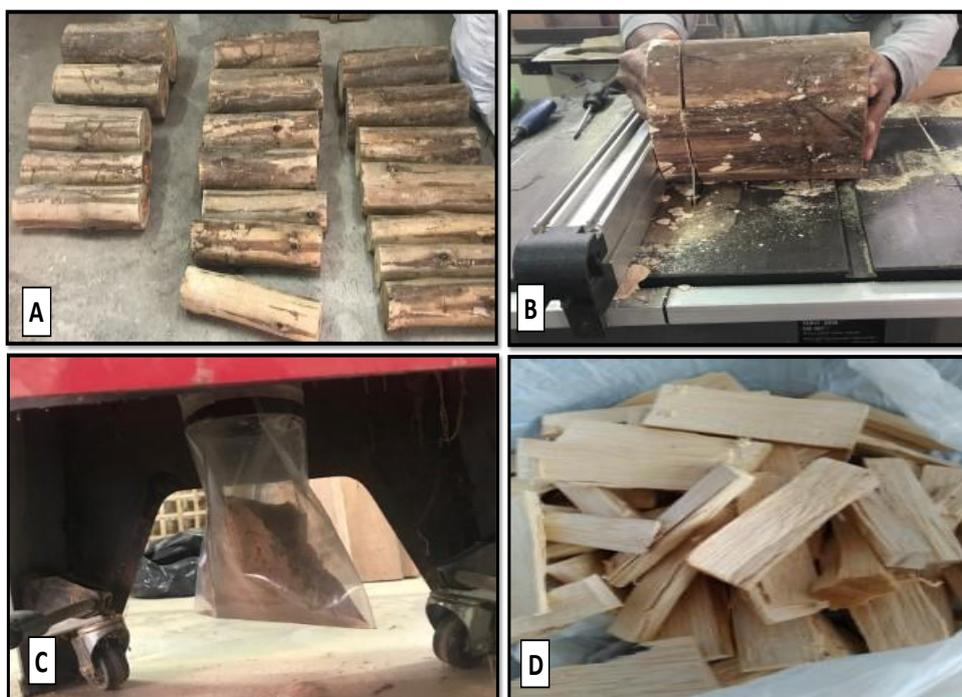
(A) Secado al ambiente, (B) Obtención de rodajas de 3 cm de espesor (C) Recolección de Aserrín y (D) Chips de bolaina blanca
