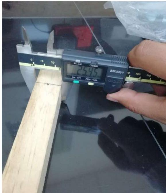
Figura 7. Medición de espesor y ancho de probetas
