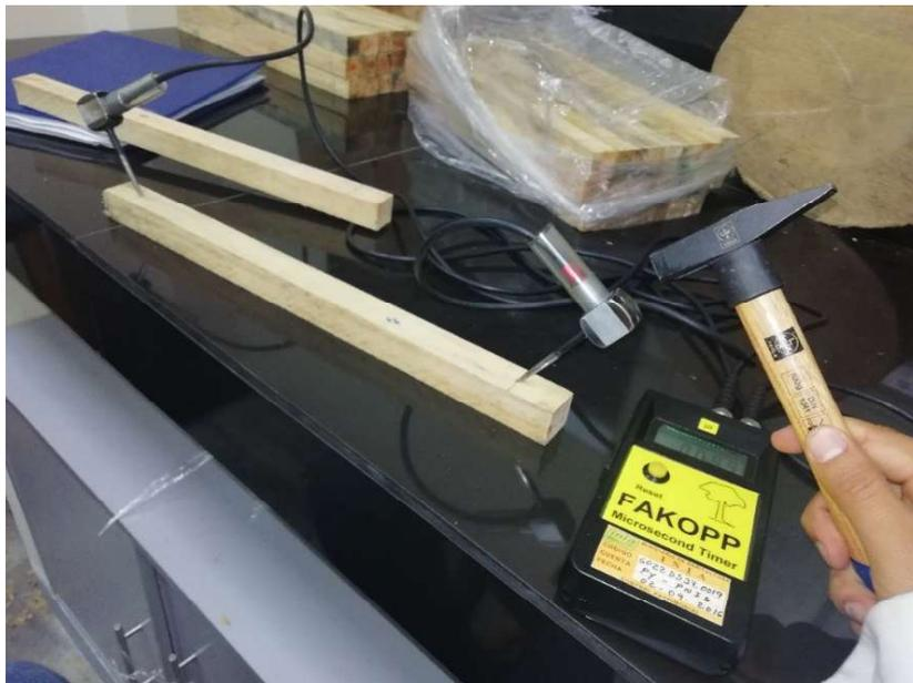
**Figura 8. Colocación de los sensores de Microsecond Timer.**
