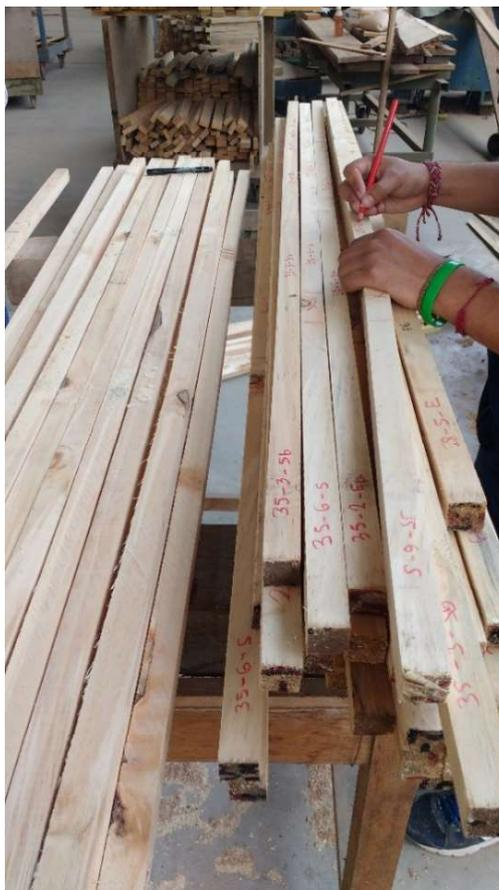
**Figura 6. Codificación de probetas**
