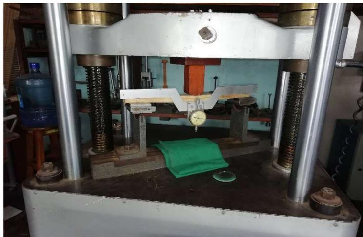
**Figura 10. Ensayo de flexión estática en prensa universal**
